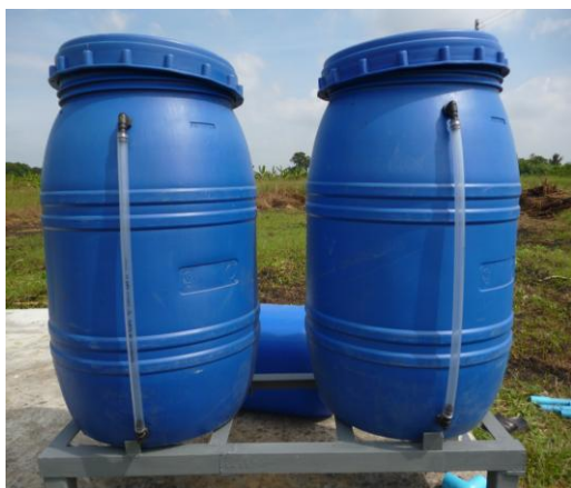
ภาพที่ 19 ติดสายยาง เพื่อวัดระดับน้ำ
