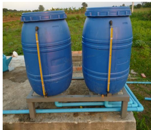
ภาพที่ 20 ติดเทปวัดระดับ เพื่ออ่านระดับน้ำ
