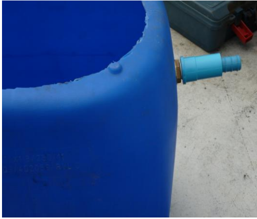
ภาพที่ 21 เปิดปากแกลลอนและเจาะรูด้านข้าง
