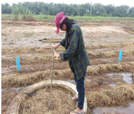
ภาพที่ 17 ใช้ Auger เจาะดิน
