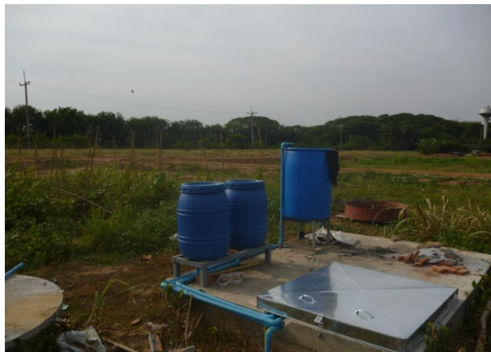
ภาพที่ 33 บริเวณที่ติดตั้งถังวัดการใช้น้ำของพืชแบบน้ำใต้ดินคงที่
