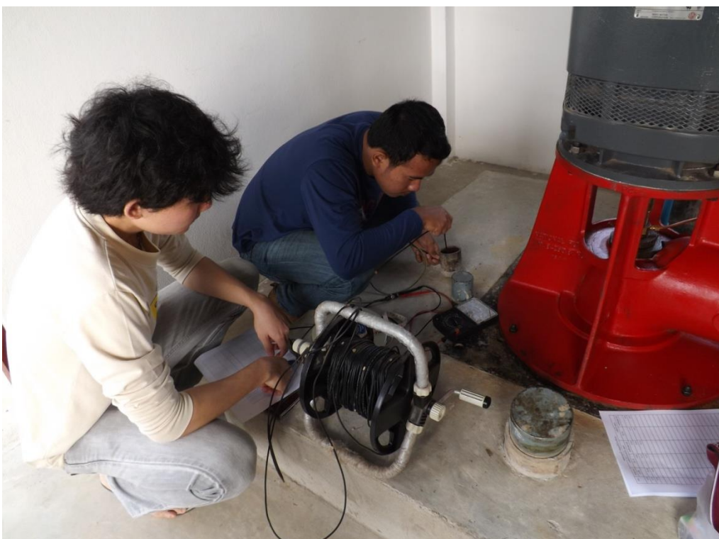
ภาพที่ 3.3.4 วัดระดับน้ำในบ่อสูบทดสอบ(Pumping well)
