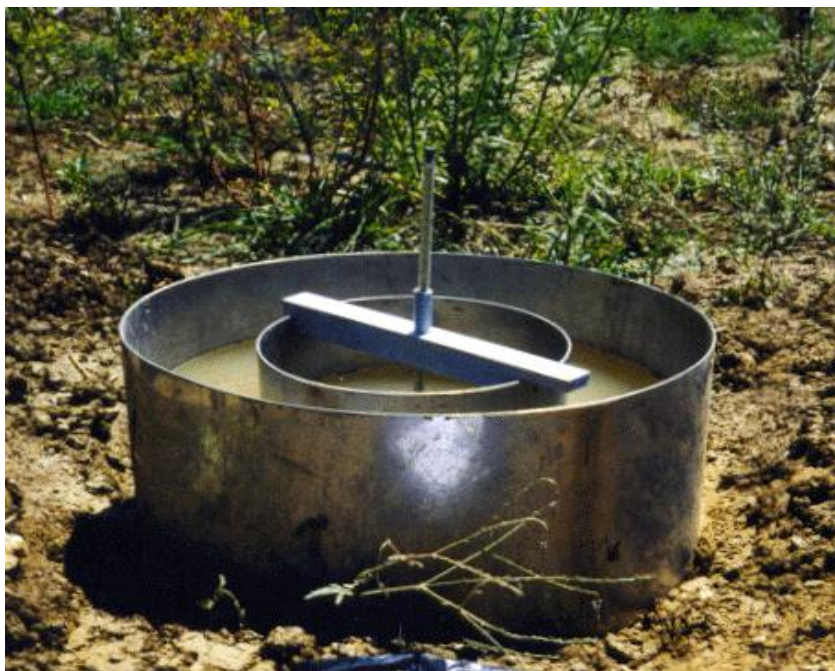
ภาพที่ 6 อุปกรณ์ Double Ring Infiltrometer
