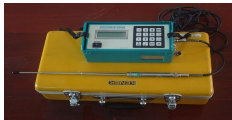
รูปที่ 7 เครื่องวัดความเร็วน้ำแบบ Electromagnetic
