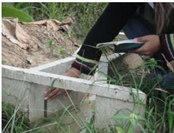
ภาพภาคผนวกที่ 42 ภาพขณะวัดปริมาณน้ำที่ไหลเข้า Flume
