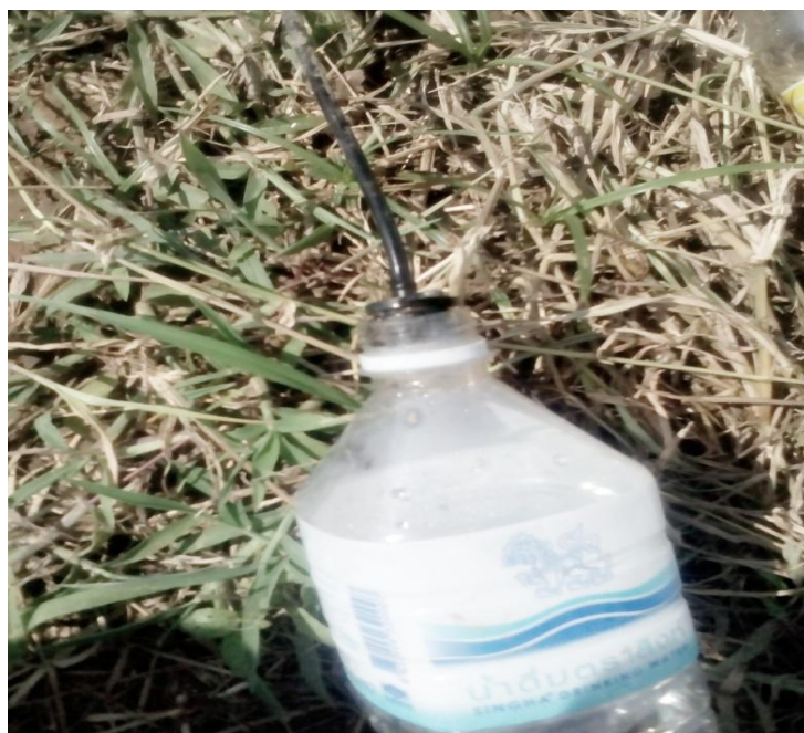
ภาพที่ 3.16 การวัดอัตราการไหลของน้ำหยดด้วยขวดน้ำ 1.5 ลิตร
