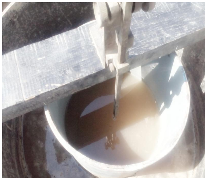
ภาพที่ 3.11 การวัดระดับน้ำที่ซึมลงใต้ดิน
