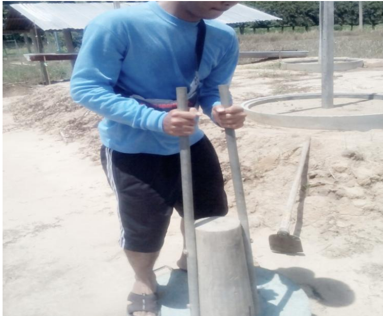
ภาพที่ 3.10 การตอกถังวัดอัตราการซึม
