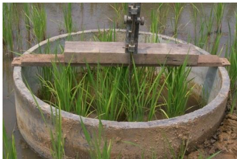
ภาพ ที่ 23 นำ Hook gage วัดระดับน้ำในถัง
