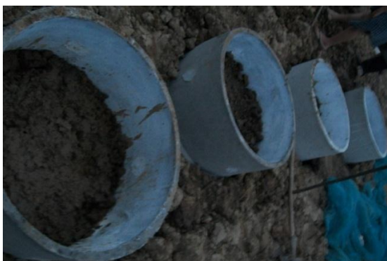
ภาพที่ 25 ถังวัดการใช้น้ำของข้าวขณะทำการติดตั้ง (ถังที่ 1 นับจากทางขวามือ ถัดมาคือ ถังที่ 2,3 และ 4 ตามลำดับ)
