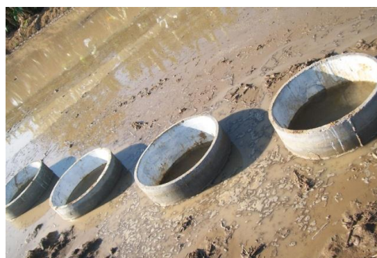
ภาพที่ 26 ถังวัดการใช้น้ำของข้าวเมื่อทำการติดตั้งเสร็จ (ถังที่ 1 นับจากทางขวามือ ถัดมาคือ ถังที่ 2,3 และ 4 ตามลำดับ)
