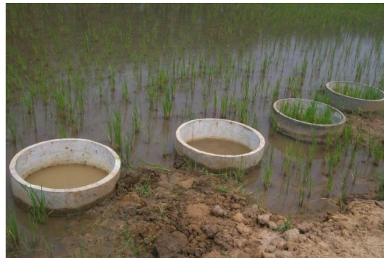
ภาพที่ 28 ถังวัดการใช้น้ำของข้าวเมื่อทดลองปลูกข้าว (ถังที่ 1 นับจากทางขวามือ ถัดมาคือ ถังที่ 2,3 และ 4 ตามลำดับ)
