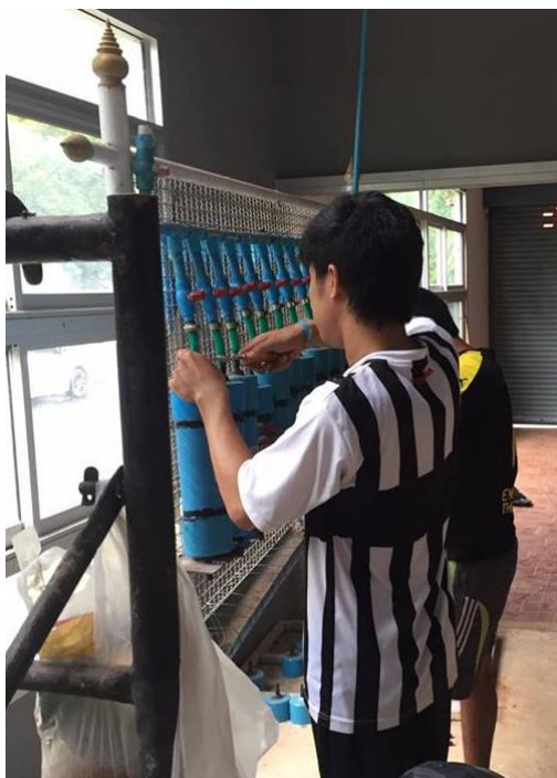
รูปที่ 3.10 นำโม่ทดสอบประกอบเข้ากับชุดทดสอบแบบ Permeability Test
