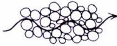
รูปที่ 2.3 การไหลซึมของน้ำผ่านมวลดิน ที่มา: สุทธิศักดิ์ (2559)
