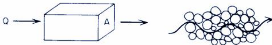
รูปที่ 2.4 การไหลของปริมาณน้ำผ่านมวลดิน ที่มา: สุทธิศักดิ์ (2559)
