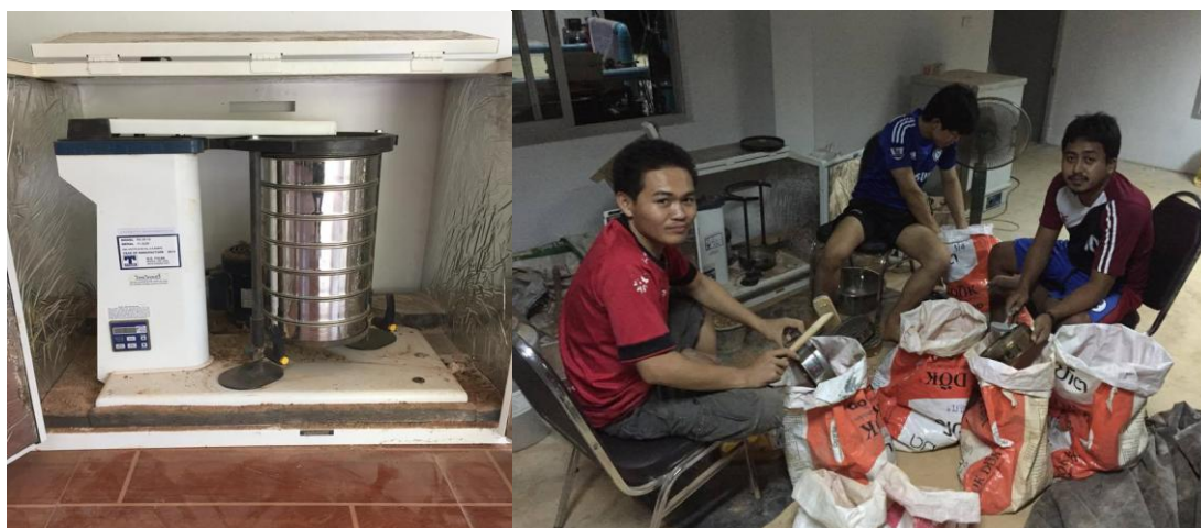
รูปที่ 3.5 การหาขนาดมวลคละของเม็ดดิน
