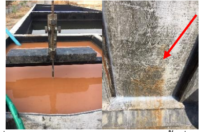
ภาพที่ 30 การวัดอัตราการรั่วซึมผ่านของน้ำที่ปนเปื้อน ตะกอนและการไหลของตะกอนผ่านรอยแตกผ้าใบ
