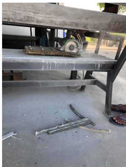
รูปผนวกที่ ก9 ตัดผ้าใบคอนกรีตเพื่อจะ นำไปทดสอบแรงดึง
