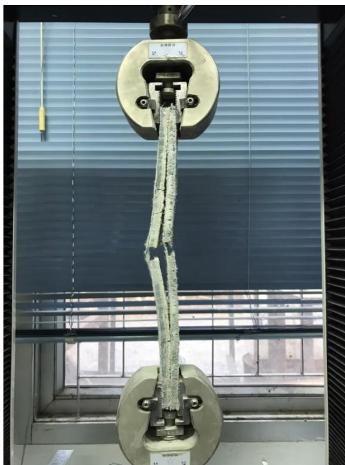
รูปผนวกที่ ข12 ตัวอย่างขั้นตอนทดสอบแรงดึงตัวเชื่อมประสานชนิดมอร์ต้าร์ ขนาด 3.5 x 30 ซม.
