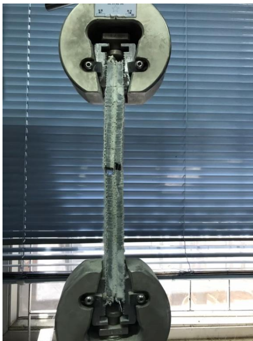
รูปผนวกที่ ข17 ตัวอย่างชิ้นทดสอบแรงดึงตัวเชื่อมประสานชนิดมอร์ตาร์ ขนาด 3.5 x 20 ซม.และหมุดยึด ชนิดน็อตสกรูที่ระยะ 5 ซม.
