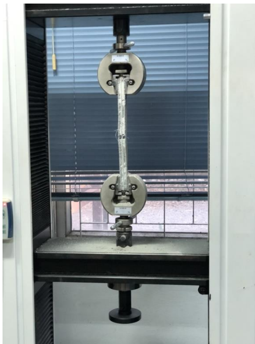
รูปผนวกที่ ข27 ตัวอย่างชิ้นทดสอบแรงดึงตัวเชื่อมประสานชนิดซิลิโคน ขนาด 3.5 x 20 ซม.และหมุดยึด ชนิดน็อตสกรูที่ระยะ 5 ซม.
