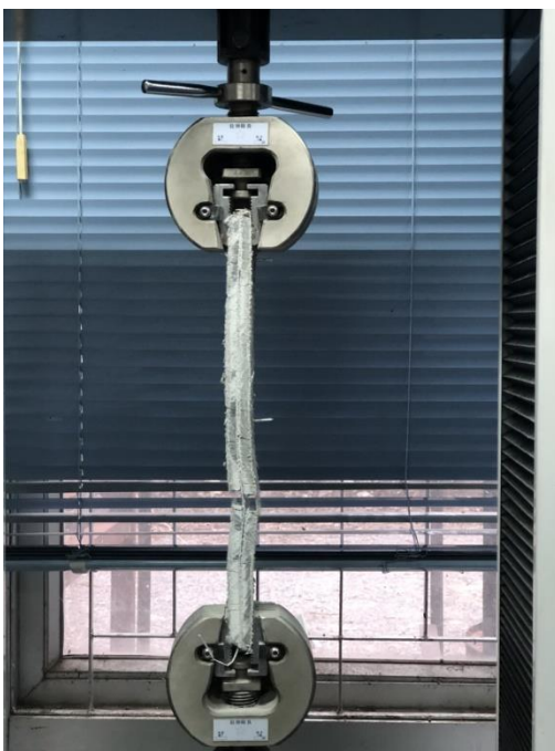
รูปผนวกที่ ข26 ตัวอย่างชิ้นทดสอบแรงดึงตัวเชื่อมประสานชนิดซิลิโคน ขนาด 3.5 x 30 ซม.และหมุดยึดชนิด ตะปูที่ระยะ 15 ซม.
