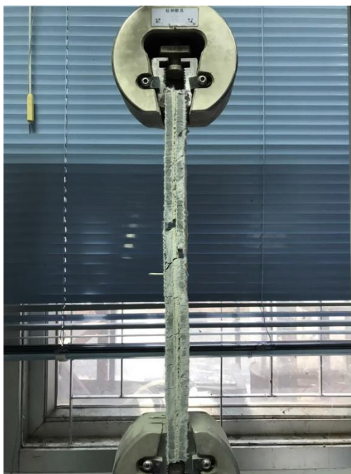
รูปผนวกที่ ข16 ตัวอย่างชิ้นทดสอบแรงดึงตัวเชื่อมประสานชนิดมอร์ตาร์ ขนาด 3.5 x 30 ซม.และหมุดยึด ชนิดตะปูที่ระยะ 15 ซม.
