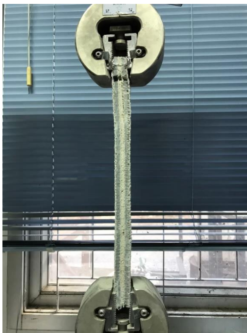
รูปผนวกที่ ข20 ตัวอย่างชิ้นทดสอบแรงดึงตัวเชื่อมประสานชนิดมอร์ตาร์ ขนาด 3.5 x 30 ซม.และหมุดยึด ชนิดน็อตสกรูที่ระยะ 15 ซม.
