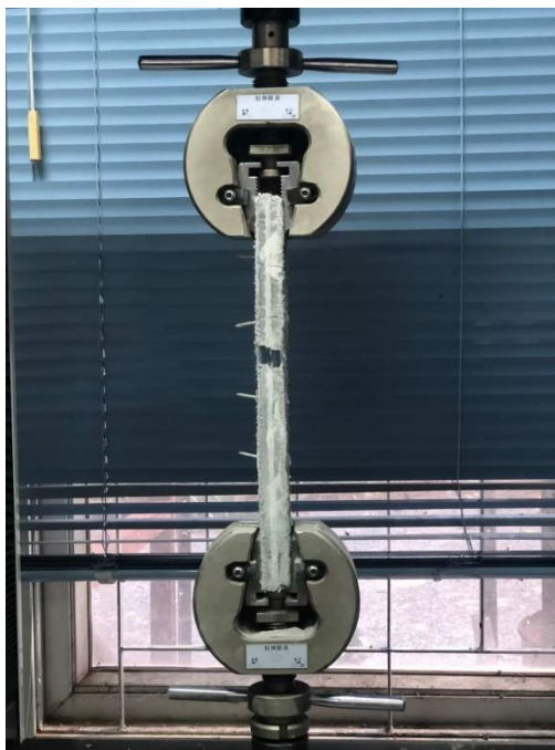
รูปผนวกที่ ข3 ตัวอย่างชิ้นทดสอบแรงดึงตัวเชื่อมประสานชนิดซีเมนต์เฟลส ขนาด 3.5 x 20 ซม.และหมุดยึด ชนิดตะปูที่ระยะ 5 ซม.
