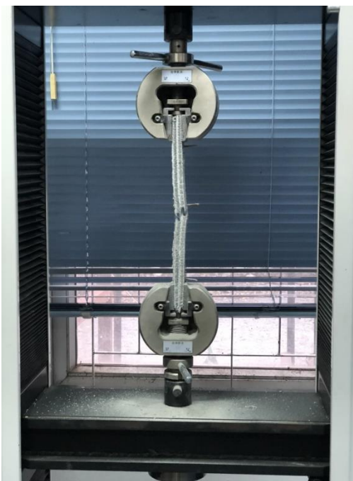
รูปผนวกที่ ข24 ตัวอย่างชิ้นทดสอบแรงดึงตัวเชื่อมประสานชนิดซิลิโคน ขนาด 3.5 x 20 ซม.และหมุดยึดชนิด ตะปูที่ระยะ 10 ซม.
