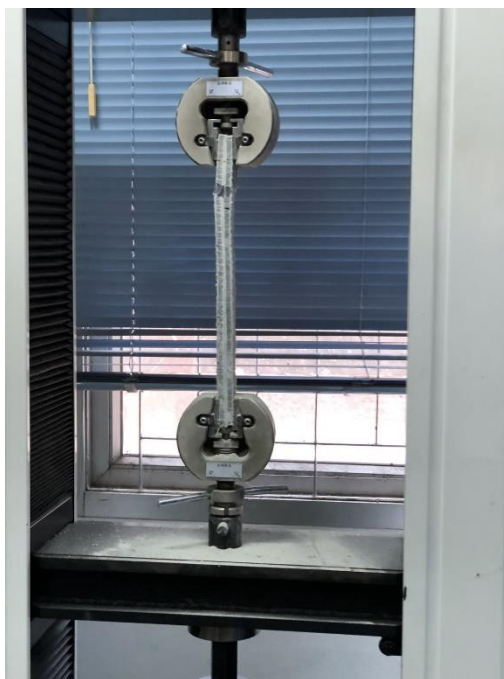
รูปผนวกที่ ข10 ตัวอย่างชิ้นทดสอบแรงดึงตัวเชื่อมประสานชนิดซีเมนต์ดพลส ขนาด 3.5 x 30 ซม.และหมุดยึดชนิดน็อตสกรูที่ระยะ 15 ซม.
