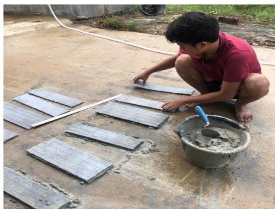
รูปผนวกที่ ก6 ทำการเชื่อมตัวประสาน ด้วยซีเมนต์เพลสและมอร์ตาร์ลง บนแผ่นผ้าใบคอนกรีต
