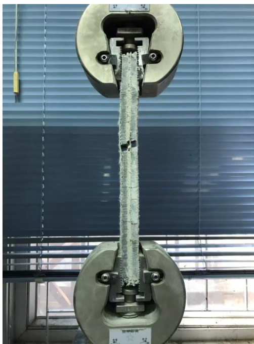
รูปผนวกที่ ข18 ตัวอย่างชิ้นทดสอบแรงดึงตัวเชื่อมประสานชนิดมอร์ตาร์ ขนาด 3.5 x 20 ซม.และหมุดยึด ชนิดน็อตสกรูที่ระยะ 10 ซม.
