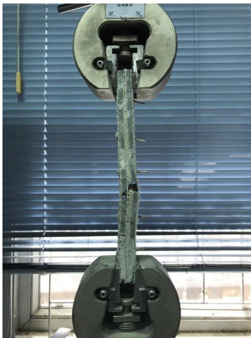
รูปผนวกที่ ข13 ตัวอย่างชิ้นทดสอบแรงดึงตัวเชื่อมประสานชนิดมอร์ต้าร์ ขนาด 3.5 x 20 ซม.และหมุดยึด ชนิดตะปูที่ระยะ 5 ซม.
