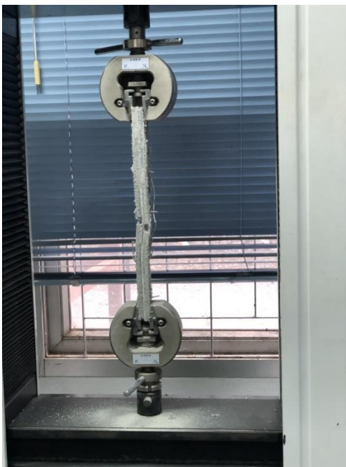
รูปผนวกที่ ข25 ตัวอย่างชิ้นทดสอบแรงดึงตัวเชื่อมประสานชนิดซิลิโคน ขนาด 3.5 x 30 ซม.และหมุดยึดชนิด ตะปูที่ระยะ 7.5 ซม.
