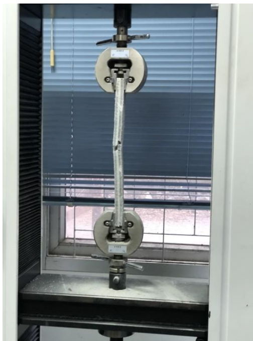
รูปผนวกที่ ข9 ตัวอย่างชิ้นทดสอบแรงดึงตัวเชื่อมประสานชนิดซีเมนต์เฟลส ขนาด 3.5 x 30 ซม.และหมุดยึดชนิดน็อตสกรูที่ระยะ 7.5 ซม.
