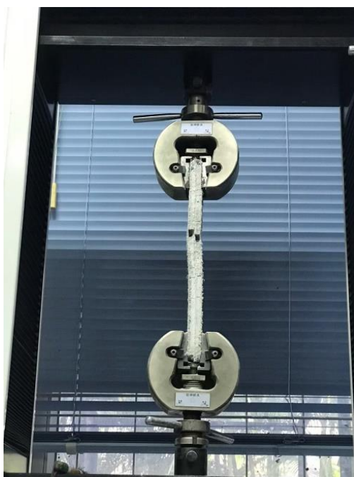
รูปผนวกที่ ข1 ตัวอย่างขั้นตอนทดสอบแรงดึงตัวเชื่อมประสานชนิดซีเมนต์เฟลส ขนาด 3.5 x 20 ซม.
