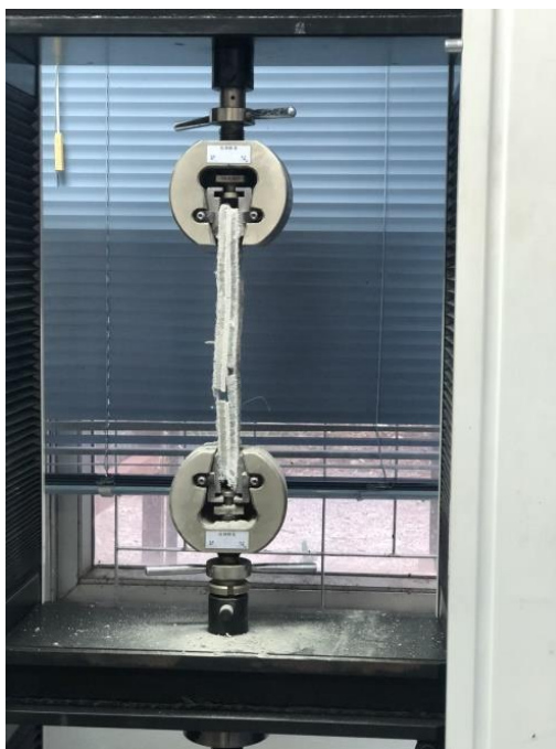
รูปผนวกที่ ข6 ตัวอย่างชิ้นทดสอบแรงดึงตัวเชื่อมประสานชนิดซีเมนต์เฟลส ขนาด 3.5 x 30 ซม.และหมุดยึด ชนิดตะปูที่ระยะ 15 ซม
