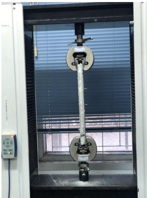
รูปผนวกที่ ข5 ตัวอย่างชิ้นทดสอบแรงดึงตัวเชื่อมประสานชนิดซีเมนต์เฟลส ขนาด 3.5 x 30 ซม.และหมุดยึด ชนิดตะปูที่ระยะ 7.5 ซม.
