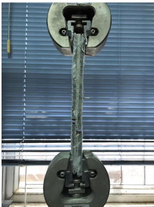
รูปผนวกที่ ข14 ตัวอย่างชิ้นทดสอบแรงดึงตัวเชื่อมประสานชนิดมอร์ต้าร์ ขนาด 3.5 x 20 ซม.และหมุดยึด ชนิดตะปูที่ระยะ 10 ซม.
