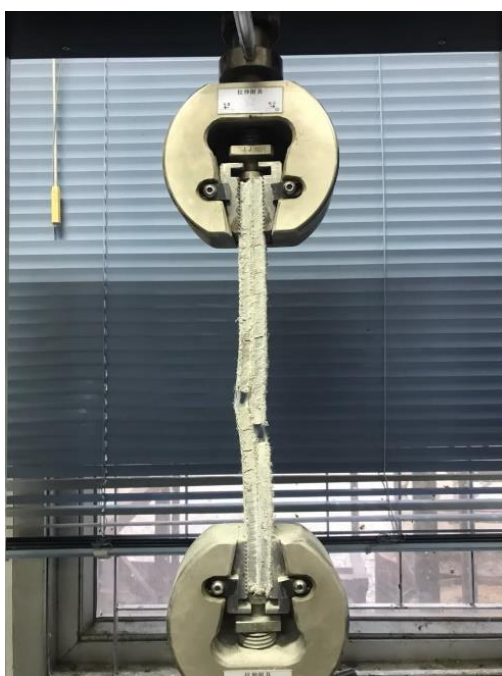
รูปผนวกที่ ข2 ตัวอย่างขั้นตอนทดสอบแรงดึงตัวเชื่อมประสานชนิดซีเมนต์เฟลส ขนาด 3.5 x 30 ซม.
