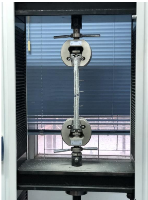
รูปผนวกที่ ข23 ตัวอย่างชิ้นทดสอบแรงดึงตัวเชื่อมประสานชนิดซิลิโคน ขนาด 3.5 x 20 ซม.และหมุดยึดชนิด ตะปูที่ระยะ 5 ซม.
