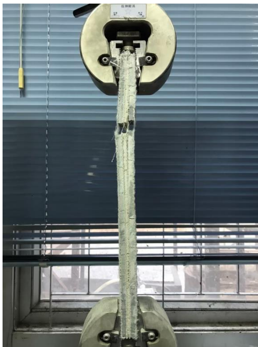
รูปผนวกที่ ข29 ตัวอย่างชิ้นทดสอบแรงดึงตัวเชื่อมประสานชนิดซิลิโคน ขนาด 3.5 x 30 ซม.และหมุดยึด ชนิดน็อตสกรูที่ระยะ 7.5 ซม.
