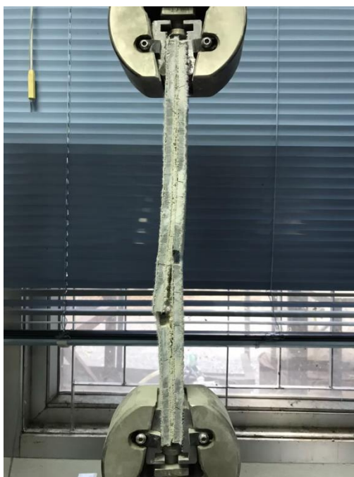
รูปผนวกที่ ข21 ตัวอย่างขั้นตอนทดสอบแรงดึงตัวเชื่อมประสานชนิดซีลิโคน ขนาด 3.5 x 20 ซม.
