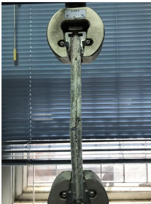
รูปผนวกที่ ข19 ตัวอย่างชิ้นทดสอบแรงดึงตัวเชื่อมประสานชนิดมอร์ตาร์ ขนาด 3.5 x 30 ซม.และหมุดยึด ชนิดน็อตสกรูที่ระยะ 7.5 ซม.
