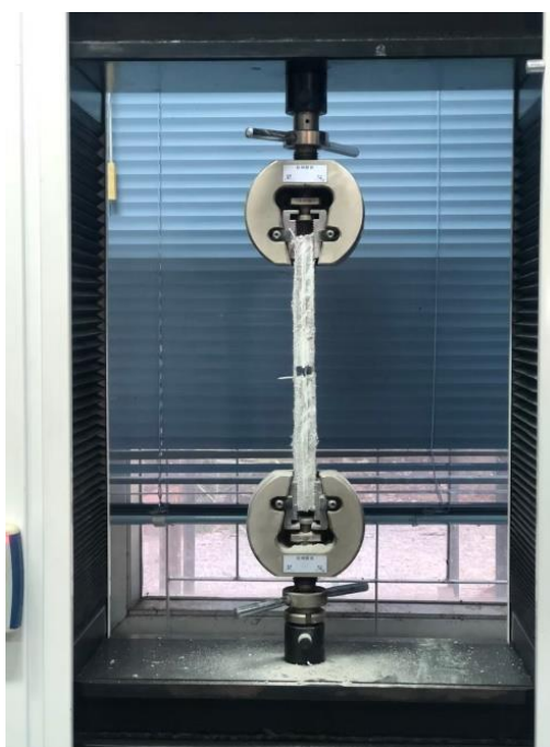
รูปผนวกที่ ข4 ตัวอย่างชิ้นทดสอบแรงดึงตัวเชื่อมประสานชนิดซีเมนต์เฟลส ขนาด 3.5 x 20 ซม.และหมุดยึด ชนิดตะปูที่ระยะ 10 ซม.
