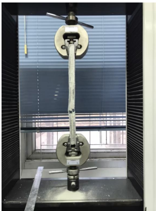
รูปผนวกที่ ข30 ตัวอย่างชิ้นทดสอบแรงดึงตัวเชื่อมประสานชนิดซิลิโคน ขนาด 3.5 x 30 ซม.และหมุดยึด ชนิดน็อตสกรูที่ระยะ 15 ซม.
