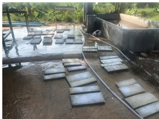
รูปผนวกที่ ก8 เอาผ้าใบคอนกรีตขึ้นจากน้ำหลัง ครบกำหนดวันบ่ม
