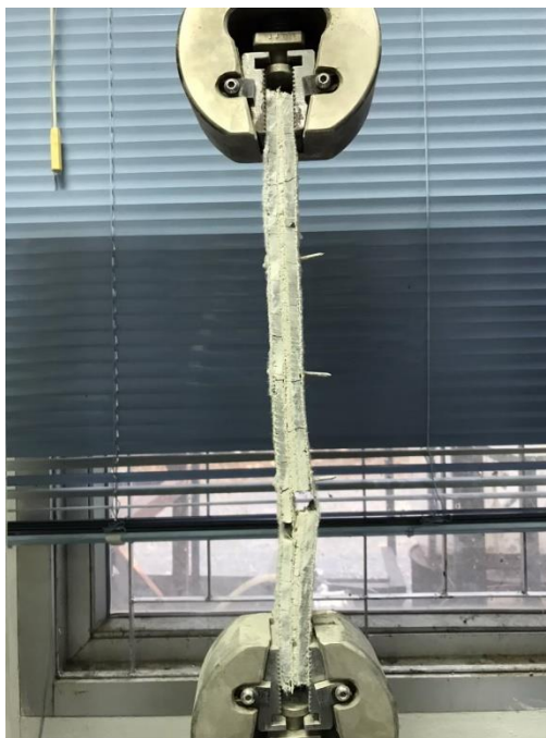
รูปผนวกที่ ข15 ตัวอย่างชิ้นทดสอบแรงดึงตัวเชื่อมประสานชนิดมอร์ตาร์ ขนาด 3.5 x 30 ซม.และหมุดยึด ชนิดตะปูที่ระยะ 7.5 ซม.
