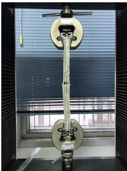
รูปผนวกที่ ข22 ตัวอย่างขั้นตอนทดสอบแรงดึงตัวเชื่อมประสานชนิดซีลิโคน ขนาด 3.5 x 30 ซม.
