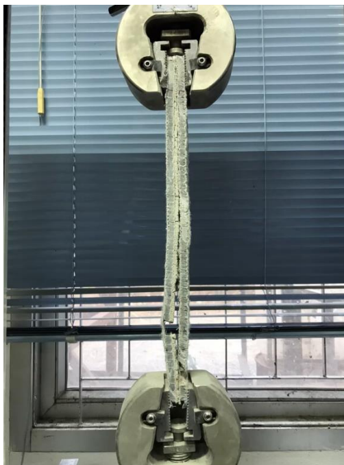
รูปผนวกที่ ข11 ตัวอย่างขั้นตอนทดสอบแรงดึงตัวเชื่อมประสานชนิดมอร์ต้าร์ ขนาด 3.5 x 20 ซม.
