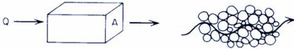
รูปที่ 2.3 อัตราการไหลซึมของน้ำผ่านมวลดิน
