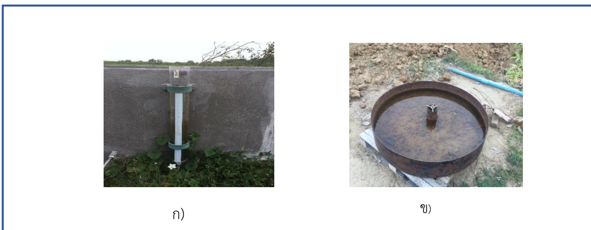
ภาพที่ 5 การติดตั้งอุปกรณ์ ก) อุปกรณ์ตรวจวัดระดับน้ำ ข) ถาดวัดการระเหย
