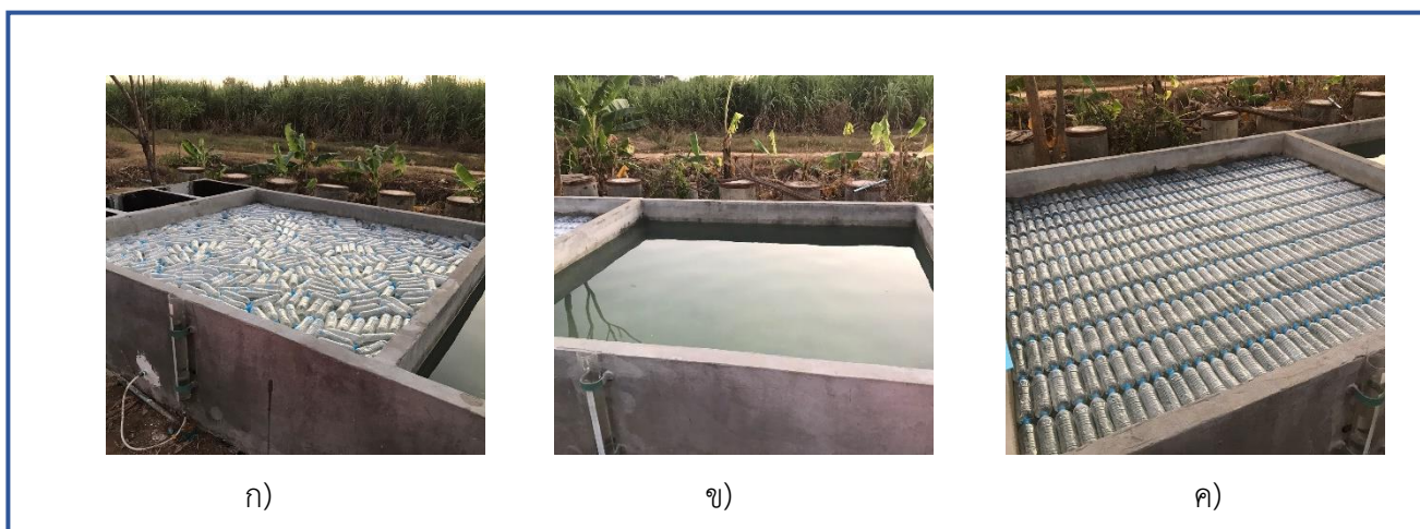
ภาพที่ 6 ก) บ่อที่ 1 ลอยขวดพลาสติกแบบวางกระจายร้อยละ 100 ของพื้นที่ ข) บ่อที่ 2 ไม่มีการลอยวัสดุ ค) บ่อที่ 3 ลอยขวดน้ำพลาสติกแบบเป็นแพร้อยละ 100 ของพื้นที่
