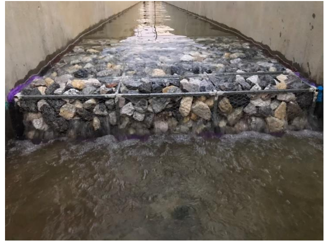
รูปผนวกที่ ข5 ทดลองอัตราการไหลผ่านฝายกล่องตาข่ายหนา 1.0 m ที่ความสูงของหิน 21 cm
