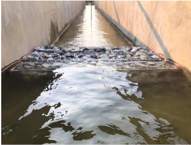
รูปผนวกที่ ข3 ทดลองอัตราการไหลผ่านฝายกล่องตาข่ายหนา 0.6 m ที่ความสูงของหิน 21 cm
