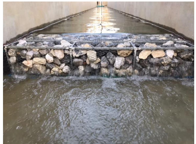
รูปผนวกที่ ข2 ทดลองอัตราการไหลผ่านฝายกล่องตาข่ายหนา 0.4 m ที่ความสูงของหิน 20 cm
