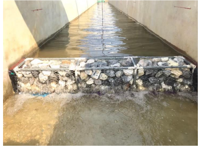
รูปผนวกที่ ข1 ทดลองอัตราการไหลผ่านฝายกล่องตาข่ายหนา 0.2 m ที่ความสูงของหิน 20 cm
