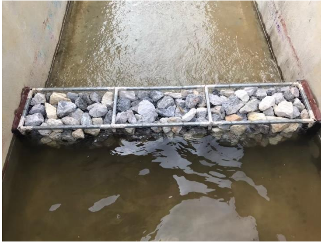
รูปผนวกที่ ข1 ทดลองอัตราการไหลผ่านฝายกล่องตาข่ายหนา 0.2 m ที่ความสูงของหิน 20 cm
