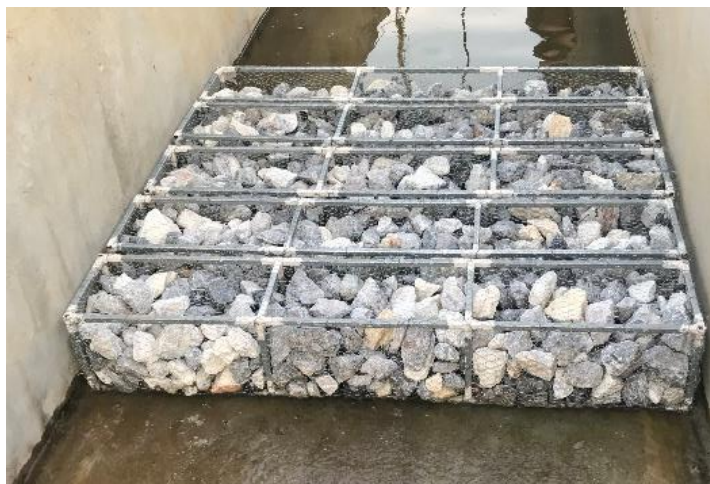
รูปที่ 10 ก่องตาข่ายที่ติดตั้งในรางทดลอง
