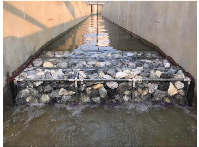
รูปผนวกที่ ข3 ทดลองอัตราการไหลผ่านฝายกล่องตาข่ายหนา 0.6 m ที่ความสูงของหิน 21 cm
