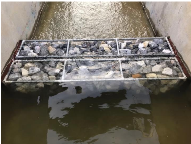
รูปผนวกที่ ข2 ทดลองอัตราการไหลผ่านฝายกล่องตาข่ายหนา 0.4 m ที่ความสูงของหิน 20 cm
