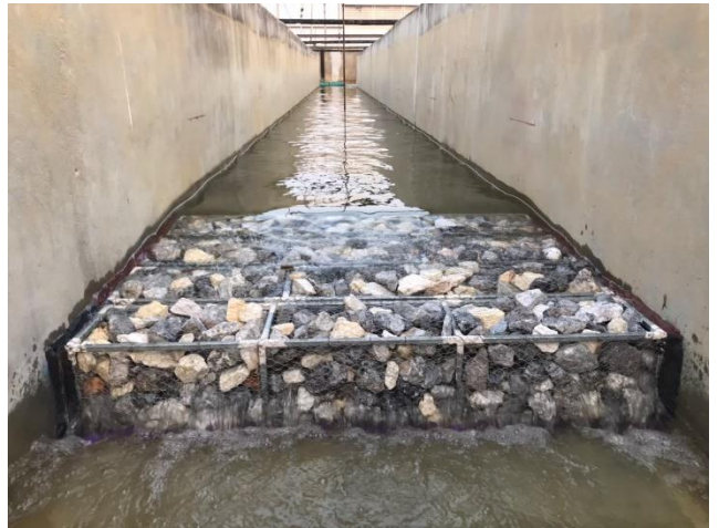
รูปผนวกที่ ข4 ทดลองอัตราการไหลผ่านฝายกล่องตาข่ายหนา 0.8 m ที่ความสูงของหิน 21 cm
