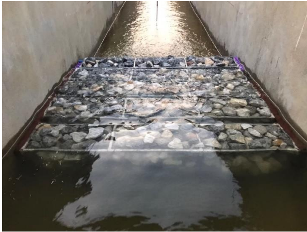
รูปผนวกที่ ข5 ทดลองอัตราการไหลผ่านฝายกล่องตาข่ายหนา 1.0 m ที่ความสูงของหิน 21 cm
