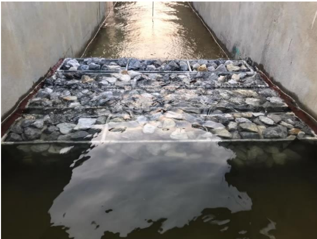
รูปผนวกที่ ข4 ทดลองอัตราการไหลผ่านฝายกล่องตาข่ายหนา 0.8 m ที่ความสูงของหิน 21 cm
