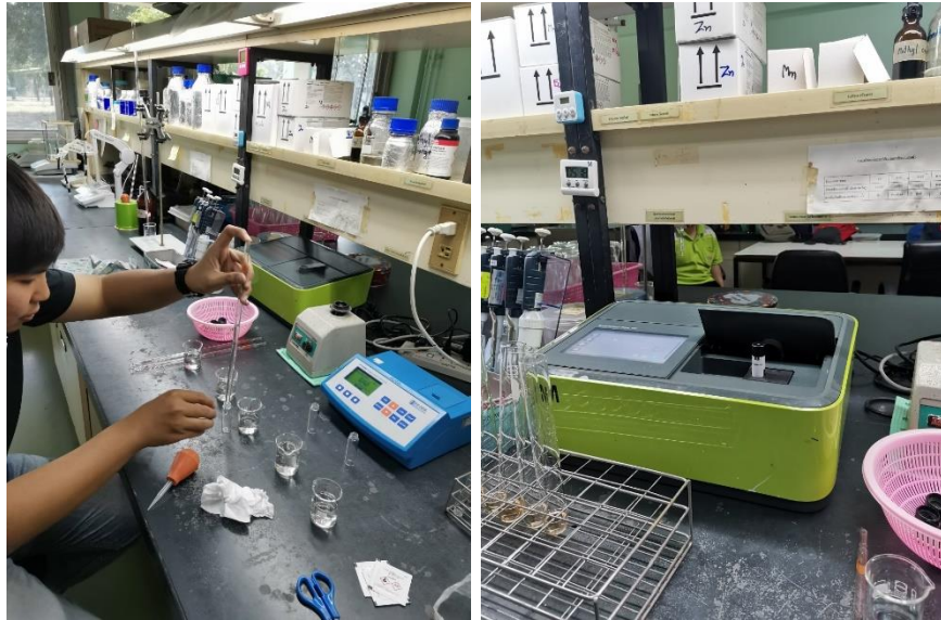
รูปที่ 10 ทำการทดลองหาค่าไนเตรทจากตัวอย่างน้ำ
