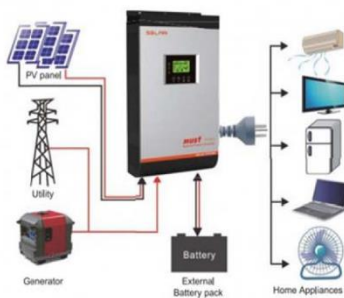
รูปที่ 2-2 การติดตั้งแผงโซลาร์เซลล์แบบ on - grid
