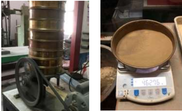
ภาพที่ 3.3 เครื่องร่อนผ่านตะแกรง จากห้องปฏิบัติการทางวิศวกรรมโยธา
