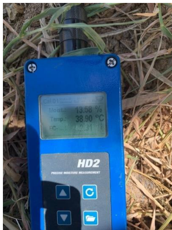
ภาพผนวกที่ ก22 การวัดความชื้นโดยเครื่อง TDR จุดที่ 9
