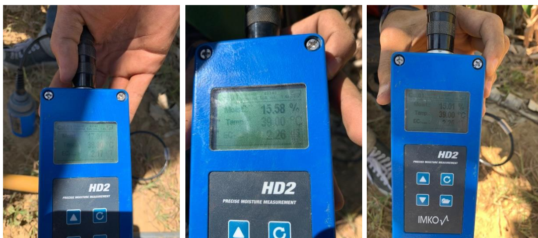
ภาพผนวกที่ ก20 การวัดความชื้นโดยเครื่อง TDR จุดที่ 8
