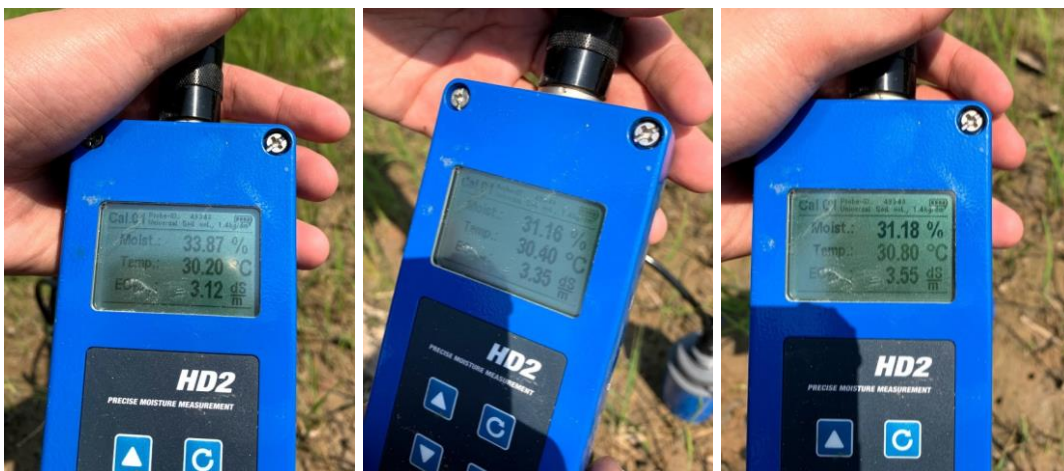
ภาพผนวกที่ ก5 การวัดความชื้นโดยเครื่อง TDR จุดที่ 2
