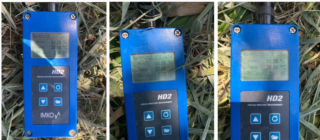
ภาพผนวกที่ ก18 การวัดความชื้นโดยเครื่อง TDR จุดที่ 7
