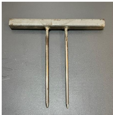
ภาพที่ 12 อุปกรณ์สำหรับเจาะนำเครื่อง TDR
