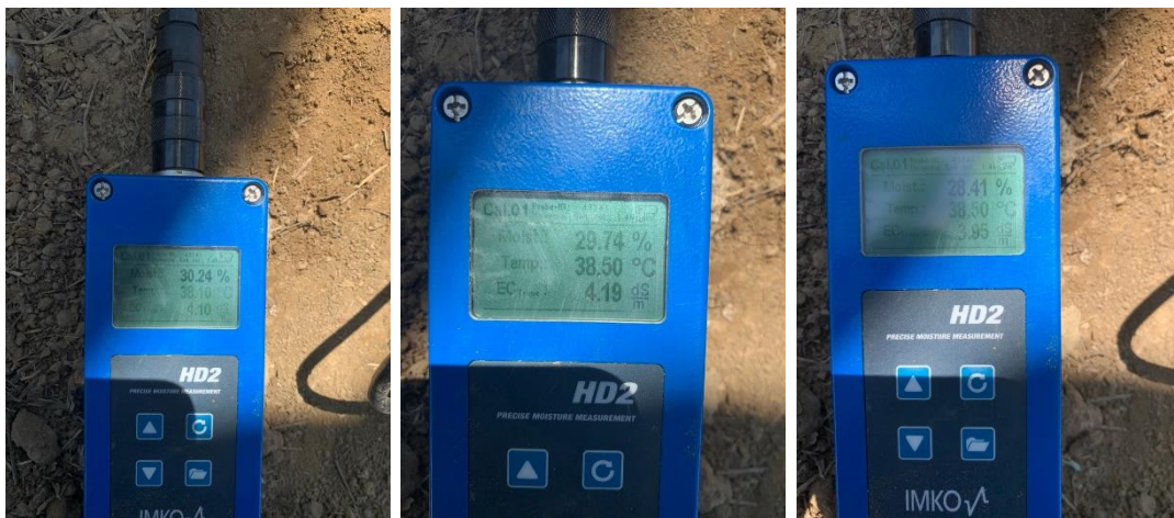
ภาพผนวกที่ ก16 การวัดความชื้นโดยเครื่อง TDR จุดที่ 6
