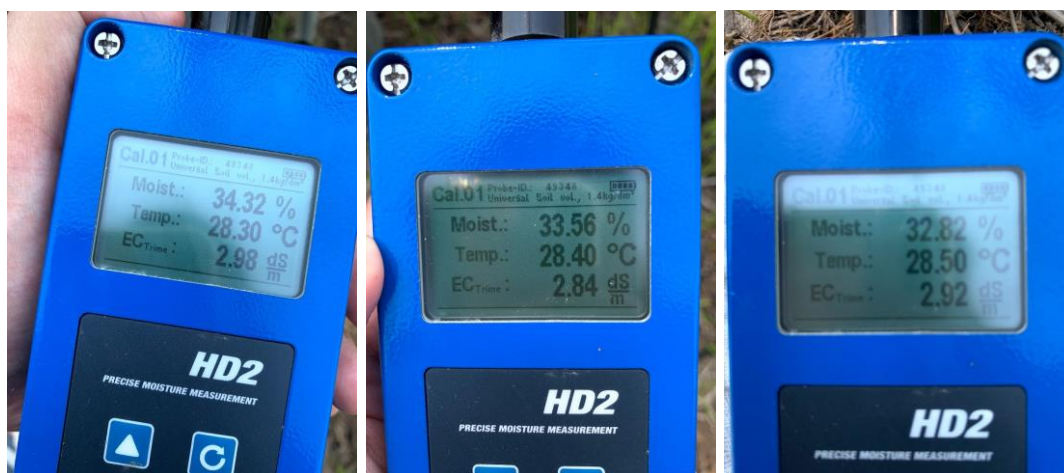
ภาพผนวกที่ ก2 การวัดความชื้นโดยเครื่อง TDR จุดที่ 1
