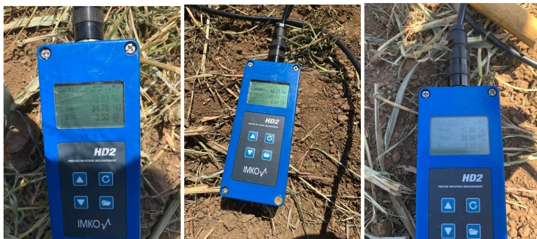
ภาพผนวกที่ ก14 การวัดความชื้นโดยเครื่อง TDR จุดที่ 5
