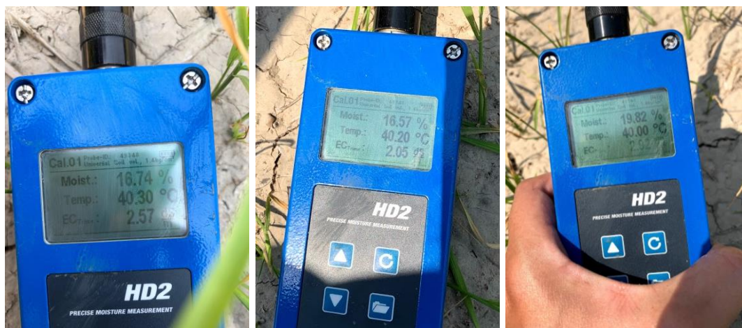
ภาพผนวกที่ ก11 การวัดความชื้นโดยเครื่อง TDR จุดที่ 4
