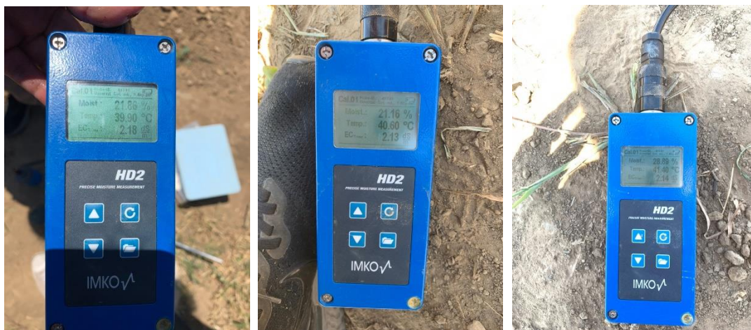
ภาพผนวกที่ ก24 การวัดความชื้นโดยเครื่อง TDR จุดที่ 10
