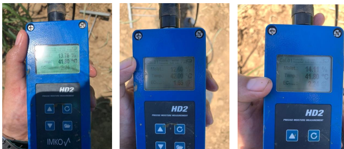
ภาพผนวกที่ ก26 การวัดความชื้นโดยเครื่อง TDR จุดที่ 10
