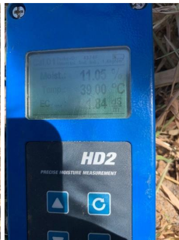
ภาพผนวกที่ ก22 การวัดความชื้นโดยเครื่อง TDR จุดที่ 9
