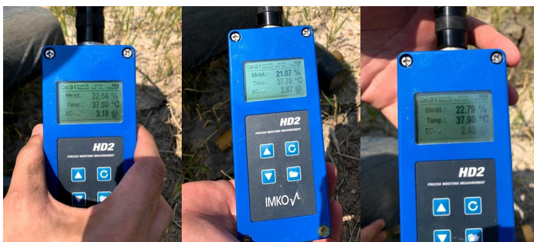
ภาพผนวกที่ ก8 การวัดความชื้นโดยเครื่อง TDR จุดที่ 3
