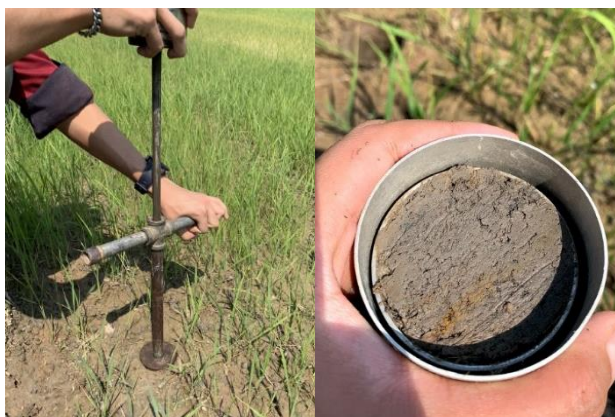
ภาพที่ 13 การเก็บตัวอย่างดินโดยใช้ Soil core sampler และดินที่ได้จากการเก็บตัวอย่างดิน
