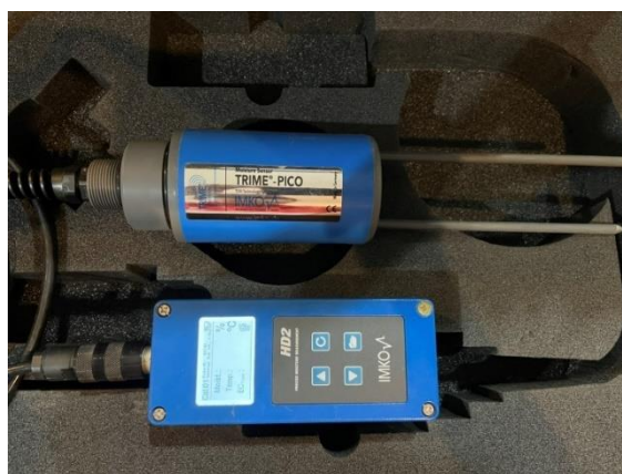
ภาพที่ 6 Time domain reflectometry (TDR) ยี่ห้อ IMKO รุ่น HD2 และ Soil moisture probe รุ่น TRIME-PICO 64
