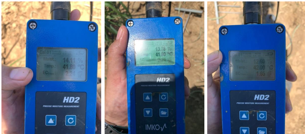
ภาพที่ จ-26 การวัดความชื้นโดยเครื่อง TDR จุดที่ 11
