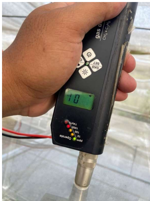
รูปที่ 3.13 วัดก๊าซมีเทนโดยเครื่องวัดปริมาณก๊าซมีเทน
