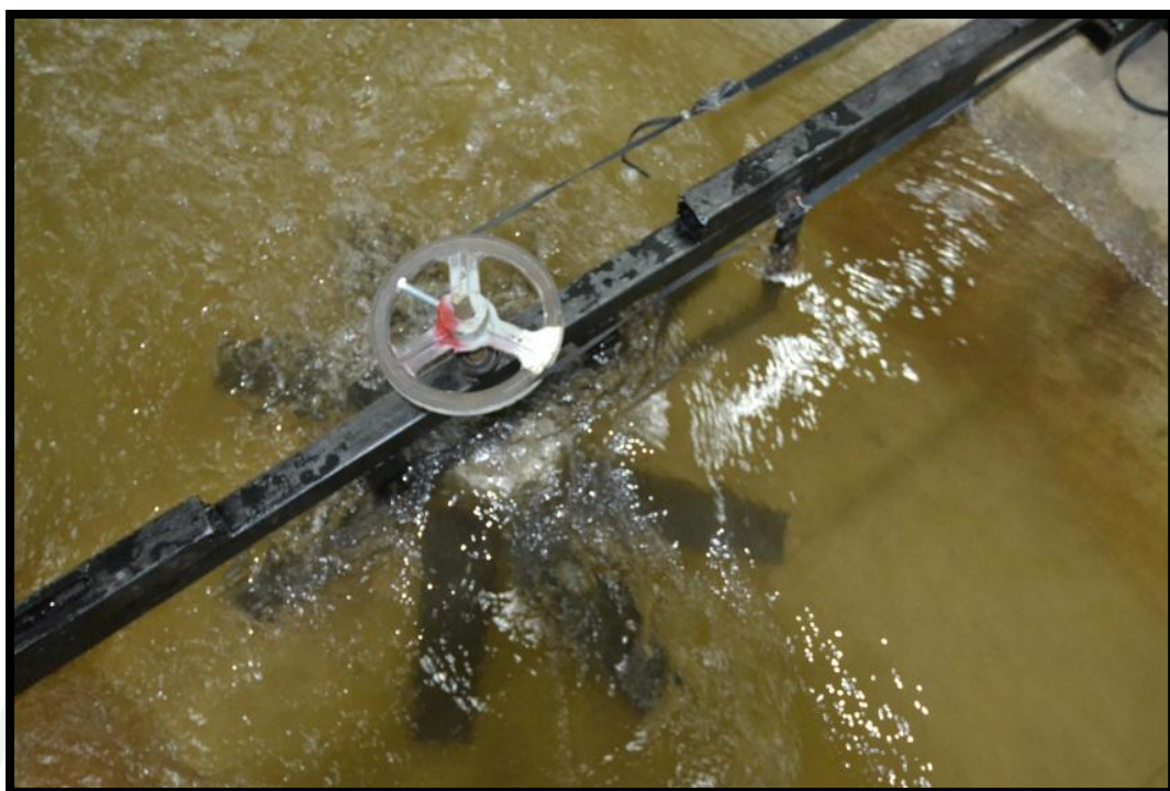
ภาพที่ 19 การทดสอบก้านที่ติดตั้งใบพัดตรงขนาด 30 \times 10 \times 0.2 เซนติเมตร จำนวน 8 ใบ
