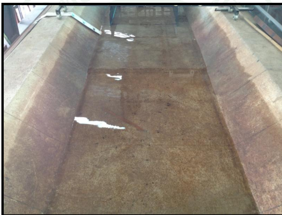
ภาพที่ 22 แบบจำลองคลองชลประทาน ณ ห้องปฏิบัติการชลศาสตร์ ภาควิชาวิศวกรรมชลประทาน
