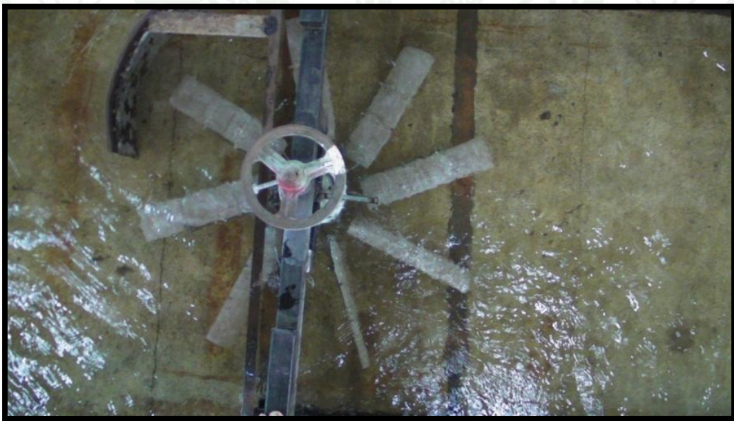
ภาพที่ 18 การทดสอบกั้นน้ำที่ติดตั้งใบพัดโค้งขนาด 30×10×1.5 เซนติเมตร จำนวน 8 ใบ
