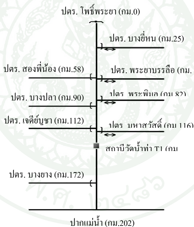
ภาพที่ 46 แผนผังสถานีตรวจวัดปริมาณน้ำ และระดับน้ำของแม่น้ำท่าจีน ตอนล่าง
