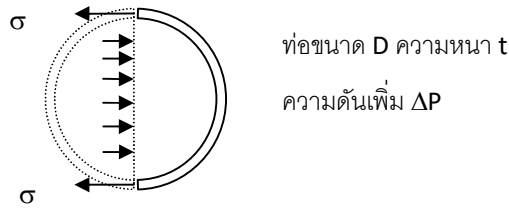
รูปที่ 3-5 ความสัมพันธ์ระหว่างความดันที่เพิ่มกับความเค้นที่ผนังท่อ
