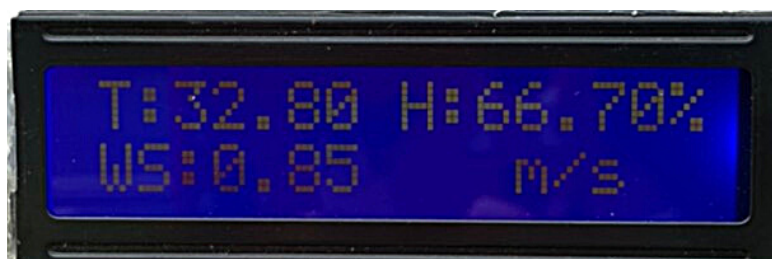
รูป 2 แสดงผลค่าอุณหภูมิ ความชื้นสัมพัทธ์ และความเร็วลมบนหน้าจอ LCD
