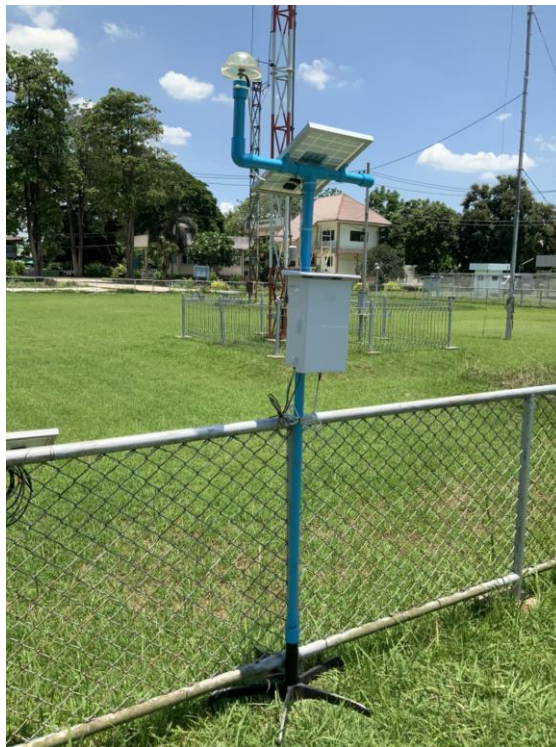
ภาพที่ 4 นำชุดโครงงานไปปรับเทียบค่าที่สถานีอุตุนิยมวิทยา ม.เกษตรศาสตร์ กำแพงแสน
