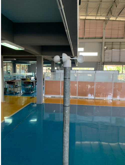
รูปที่ 11 ติดตั้งเซนเซอร์วัดความเร็วลม
