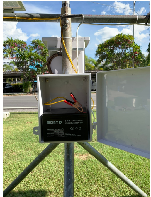
รูปที่ 15 ภายในตู้บรรจุแบตเตอรี่
