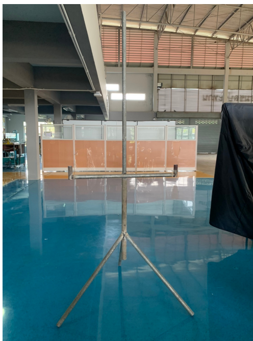
รูปที่ 8 ประกอบโครงสร้างสถานีวัดอากาศ
