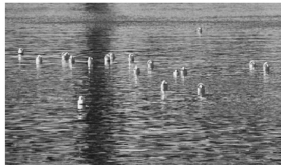
(2) ทุ่นขณะลอยติดตามสภาพการไหลของน้ำ
