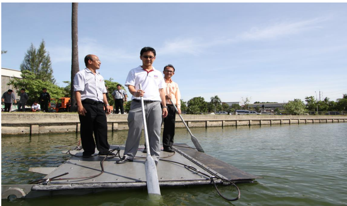
รูปที่ 7 ฝ่ายพับได้ Type III-B ออกแบบให้สามารถลอยน้ำได้ สะดวกในการขนย้ายและติดตั้ง
