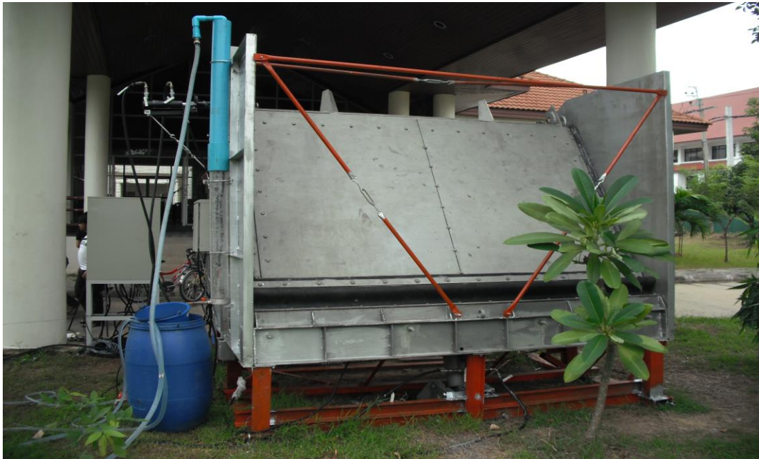
รูปที่ 8 ฝ่ายพันได้ Type III-B แบบอัตโนมัติ แบบลดยน้ำได้ ที่ติดตั้งเพื่ออบรมข้าราชการกรมชลประทาน และนิสิตวิทยาลัยการชลประทาน และผู้ที่สนใจ
