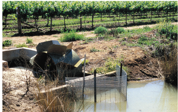
d. กังหันเดทริดจ์ (Dethridge) ที่วัดการใช้น้ำชลประทานที่ไร่องุ่น กริฟฟิธ รัฐนิวเซาท์เวลส์ (Griffith, NSW)(แหล่งข้อมูล: CSIRO ช่างภาพ: Willem van Aken วันที่ 8 พฤศจิกายน พ.ศ. 2538)
