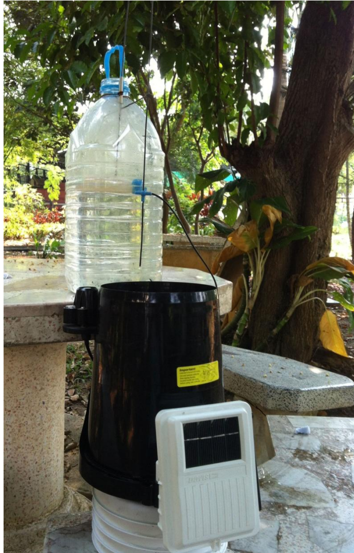
ภาพที่ 4-70 การทดสอบหาปริมาณการระบอกลงของเครื่องตรวจอากาศอัตโนมัติ
