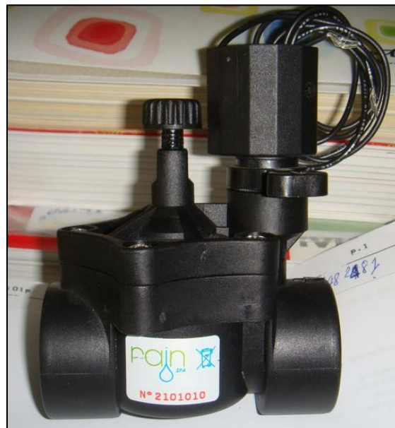
ภาพที่ 3-7 โซลินอยด์วาล์ว ขนาด 24 V.
