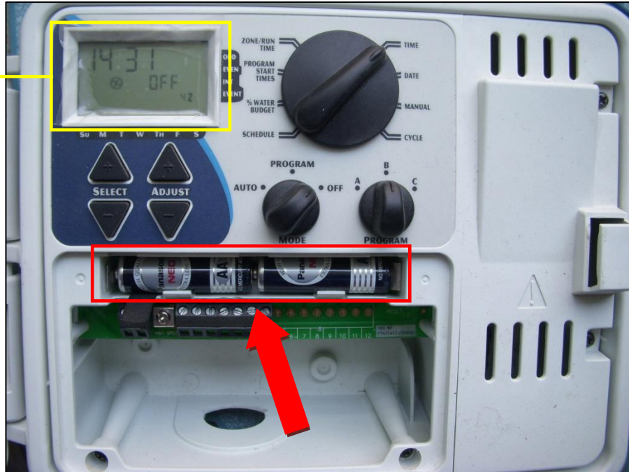
ภาพที่ 3-13 ช่องในการใส่ถ่านของเครื่องควบคุมน้ำ
