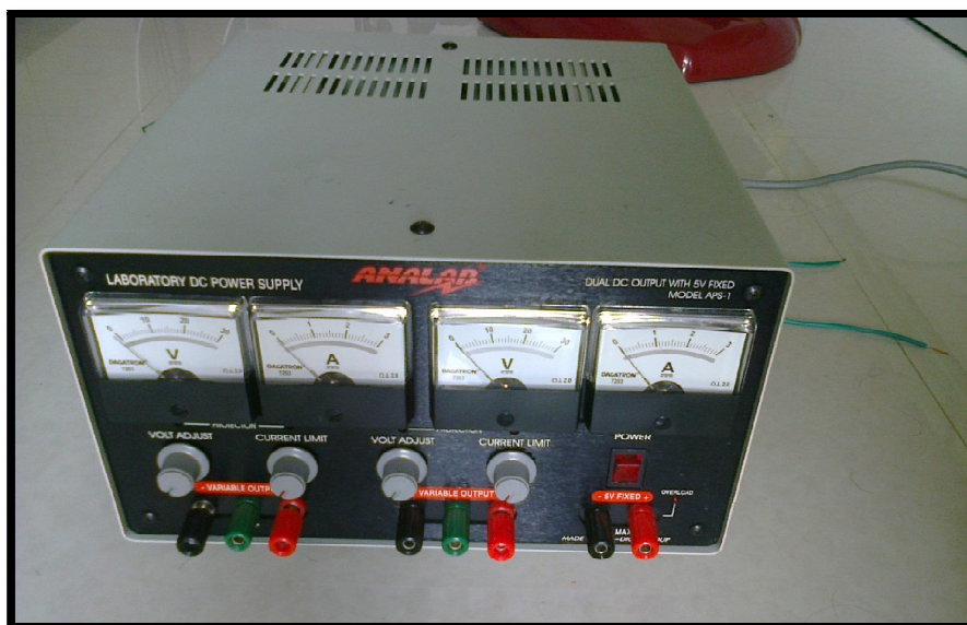
ภาพที่ 16 แหล่งจ่ายไฟ (Power supply)
