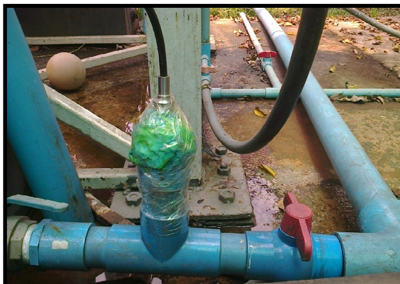
ภาพที่ 28 หัวเซนเซอร์เมื่อนำไปติดตั้งในท่อส่วนที่ยื่นออกมาจากถังน้ำ
