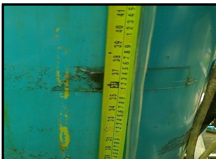
ภาพที่ 36 สายยางระดับน้ำและสายตลับเมตรที่ติดข้างถังน้ำ
