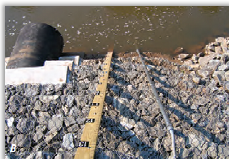
ภาพที่ 2 เครื่องมือวัดระดับน้ำแบบเอียง (Slope gage)
