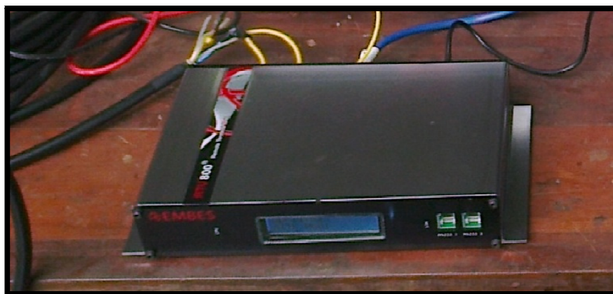
ภาพที่ 27 ต่อหัวเซนเซอร์วัดระดับน้ำกับเครื่อง RTU800
