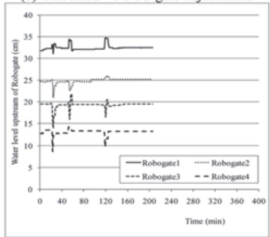
(d) Test run 4 – 3 FTO gate adjustments
