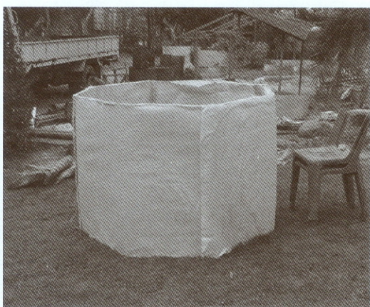
รูปที่ 8 การนำผ้าใบคอนกรีตไปทำถังน้ำ
