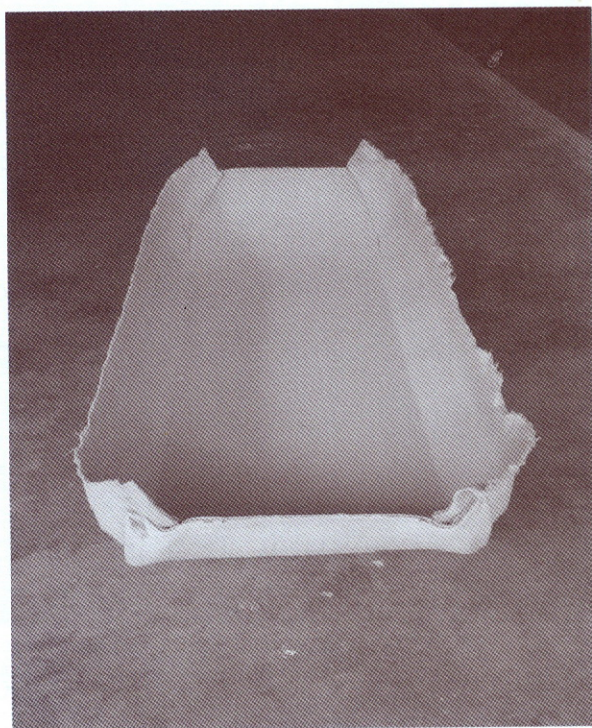
รูปที่ 9 การนำผ้าใบคอนกรีตไปขึ้นรูปเป็นเรือ
