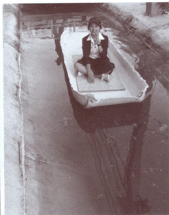
รูปที่ 9 การนำผ้าใบคอนกรีตไปขึ้นรูปเป็นเรือ
