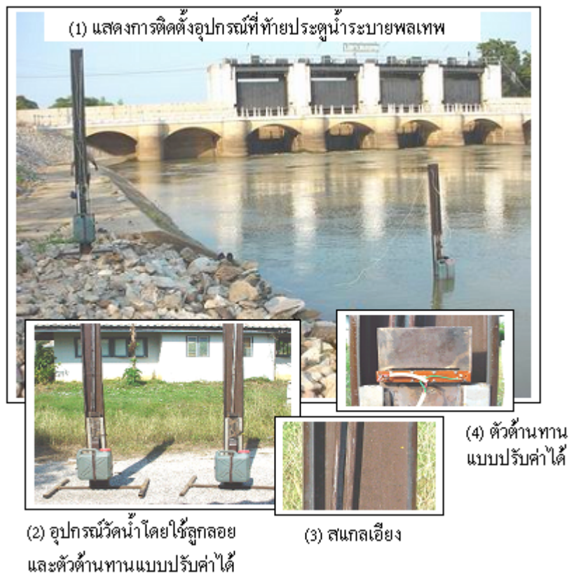
รูปที่ 2 ระบบวัดระดับน้ำโดยใช้ลูกลอย ตัวต้านทานแบบปรับค่าได้และสเกลเอียง
