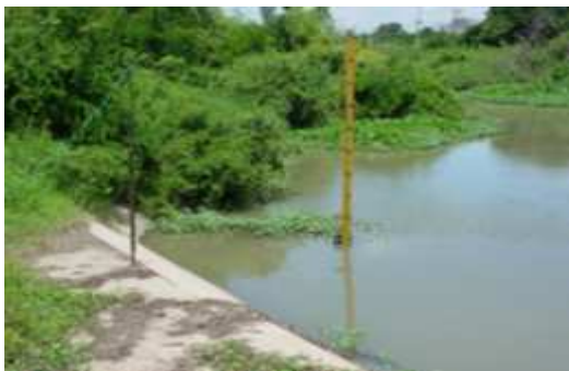
ลูกลอยที่ติดตั้งตัวต้านทานปรับค่าได้และ สเกลเอียงวัดระดับน้ำที่สถานีลูกข่าย
