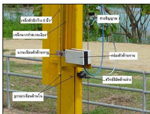
รูปที่ 4 อุปกรณ์วัดระยะการเปิดบาน ปตร.
