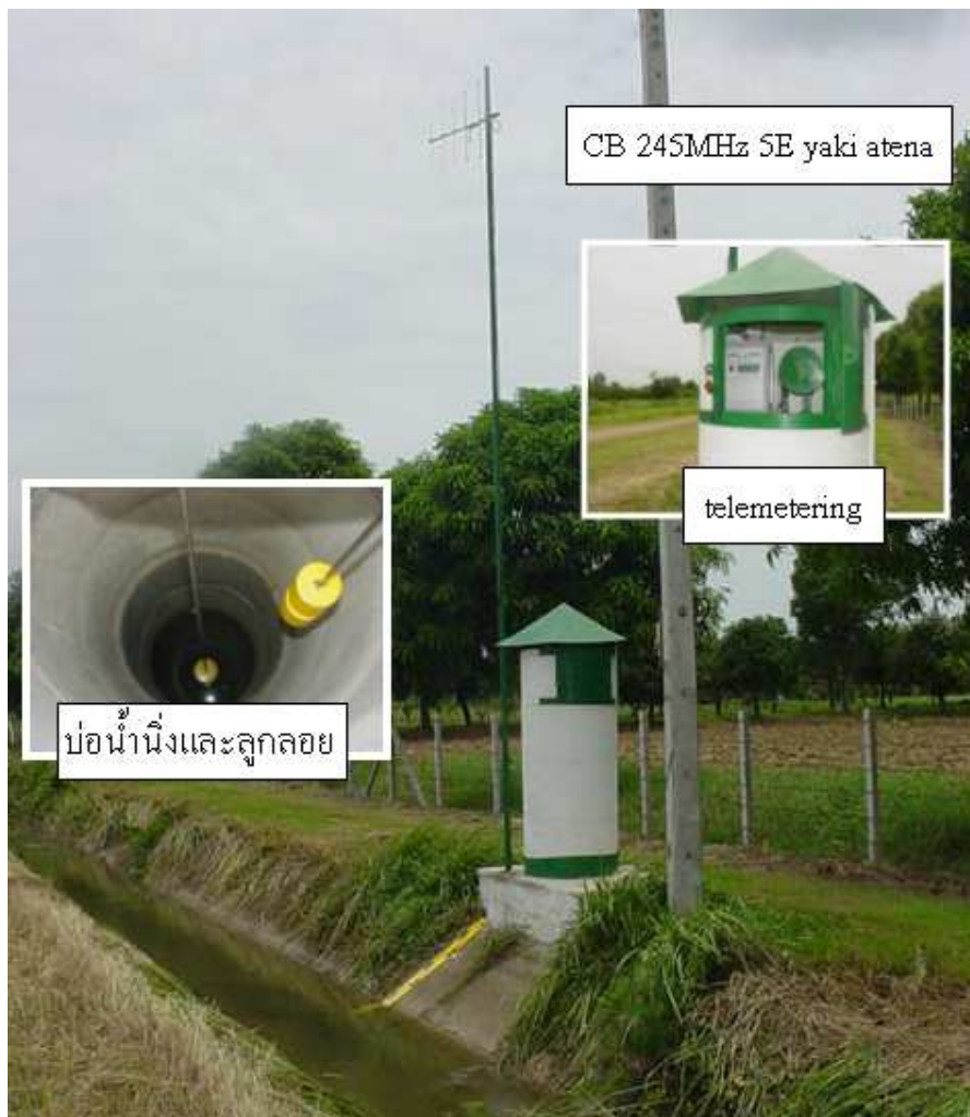
รูปที่10 สถานีวัดระดับน้ำแบบอัตโนมัติ(Telemetering)
