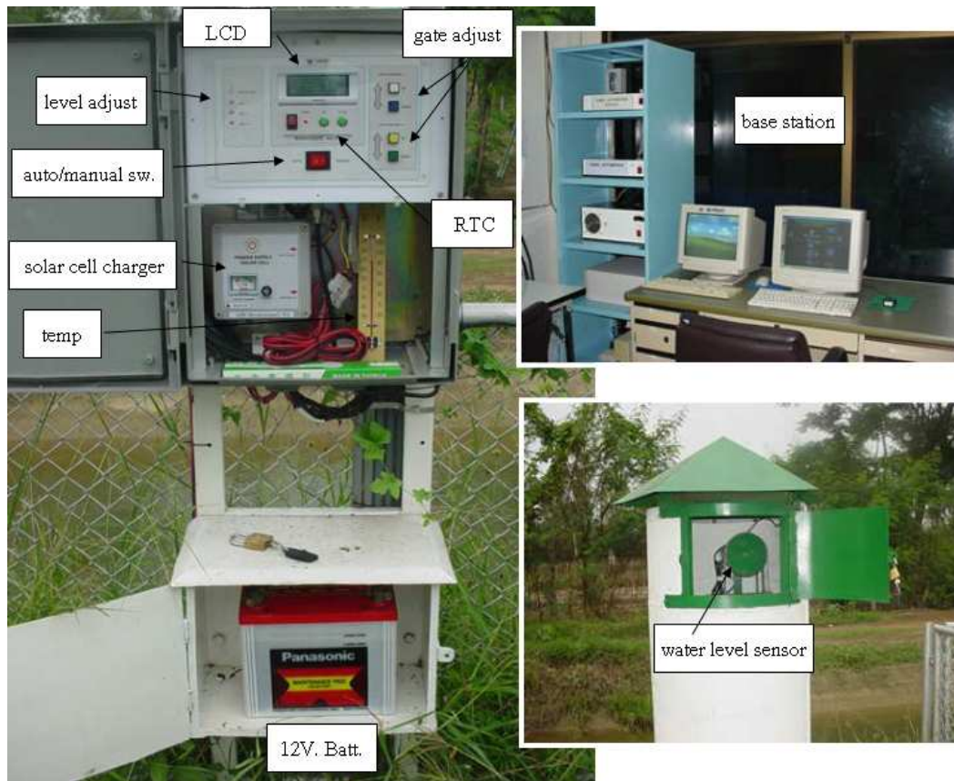
รูปที่ 8 ส่วนประกอบของ Robogate v.5
