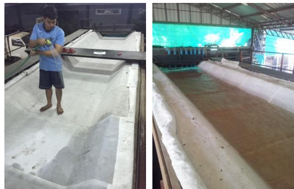
รูปที่ 2 การติดตั้งผ้าใบคอนกรีต ในห้องปฏิบัติการ
