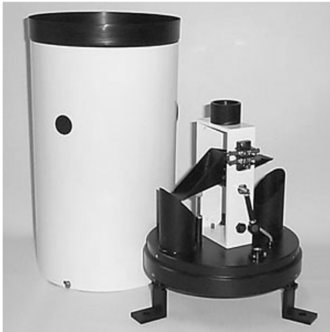
รูปที่ 2 รายละเอียด Tipping Bucket Rain Gauge ที่มา: NovaLynx Corporation (2021)
