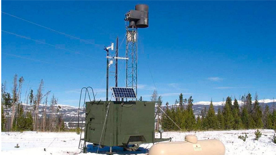
รูปที่ 2-2 ภาพตัวอย่างสถานีวัดน้ำฝนและภูมิอากาศที่จะติดตั้งเพิ่มเติมในโครงการ
