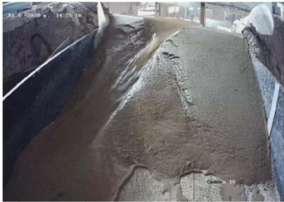
ภาพที่ ข1.4.แบบจำลองเขื่อนแก่งกระจานในขณะที่มีการไหลลงผ่านรอยแตกของเขื่อน
