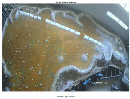
ภาพที่ ค1.8.การเคลื่อนตัวของน้ำภายในแบบจำลองอ่างเก็บน้ำแก่งกระจานด้านทิศตะวันตกเมื่อเกิดการทับถมของเขื่อน วันที่ที่ 42
