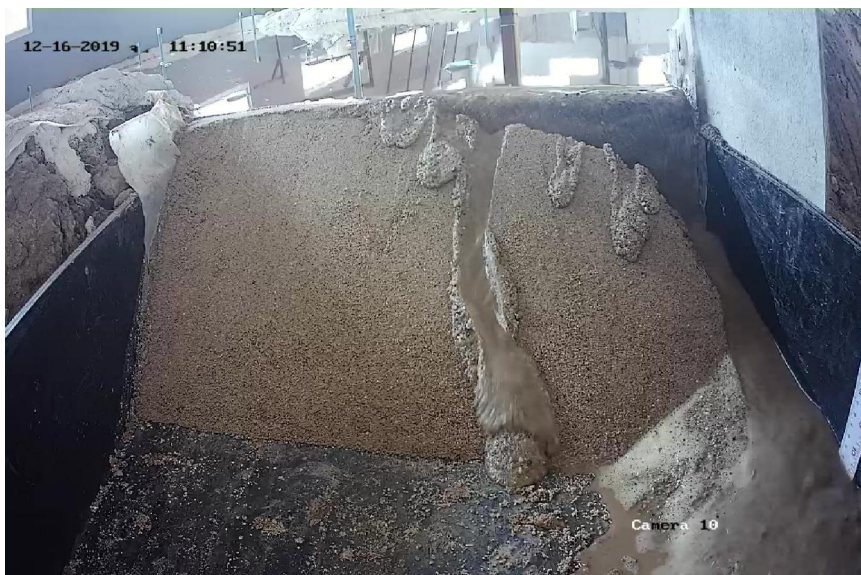
ภาพที่ ข2.4.แบบจำลองเขื่อนแก่งกระจานจำลองในขณะที่เริ่มมีการไหลผ่านด้านซ้ายของเขื่อน
