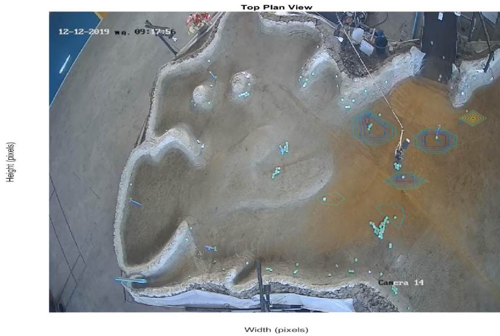
ภาพที่ ค2.11.การเคลื่อนตัวของน้ำภายในแบบจำลองอ่างเก็บน้ำแก่งกระจานด้านทิศตะวันตกเมื่อเกิดการ พิบัติของเขื่อน วินาทีที่ 103
