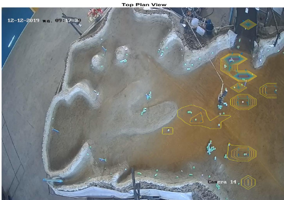
ภาพที่ ค2.10.การเคลื่อนตัวของน้ำภายในแบบจำลองอ่างเก็บน้ำแก่งกระจานด้านทิศตะวันตกเมื่อเกิดการพิบัติของเขื่อน วินาทีที่ 86
