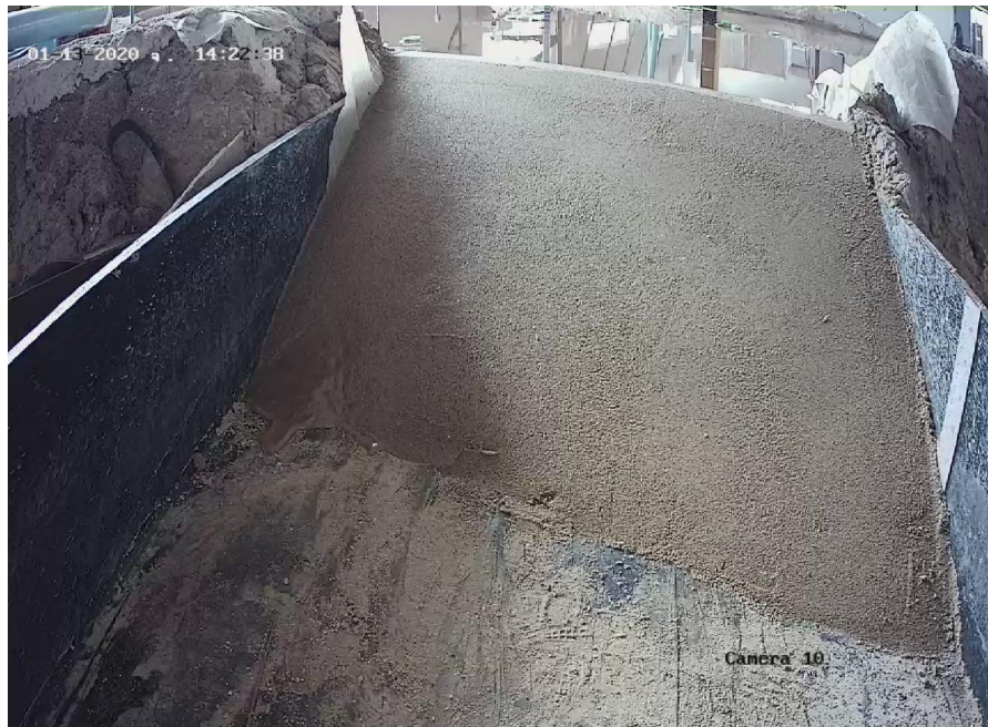
ภาพที่ ข1.2.แบบจำลองเขื่อนแก่งกระจานจำลองในขณะที่เริ่มต้นมีการไหลซึมของน้ำผ่านดินเขื่อนด้านขวา
