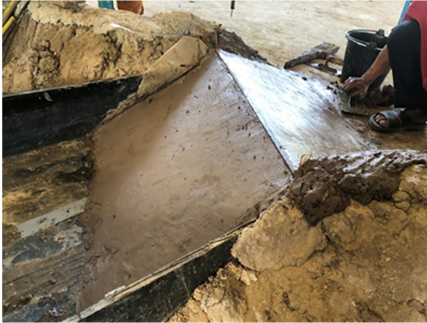
ภาพที่ 2.23 การสร้างแบบจำลองเขื่อนแก่งกระจานจากดินเหนียว
