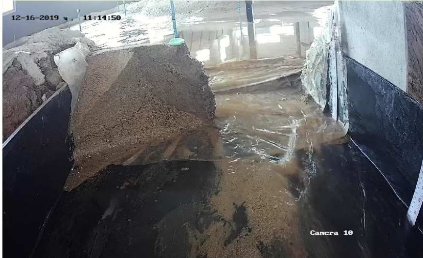
ภาพที่ ข2.9.แบบจำลองเขื่อนแก่งกระจานจำลองในตอนที่สิ้นสุดการไหลของน้ำ
