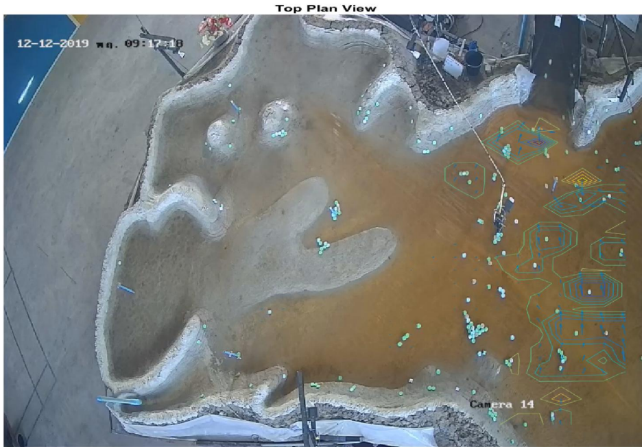
ภาพที่ ค2.9.การเคลื่อนตัวของน้ำภายในแบบจำลองอ่างเก็บน้ำแก่งกระจานด้านทิศตะวันตกเมื่อเกิดการพิบัติของเขื่อน วินาทีที่ 65
