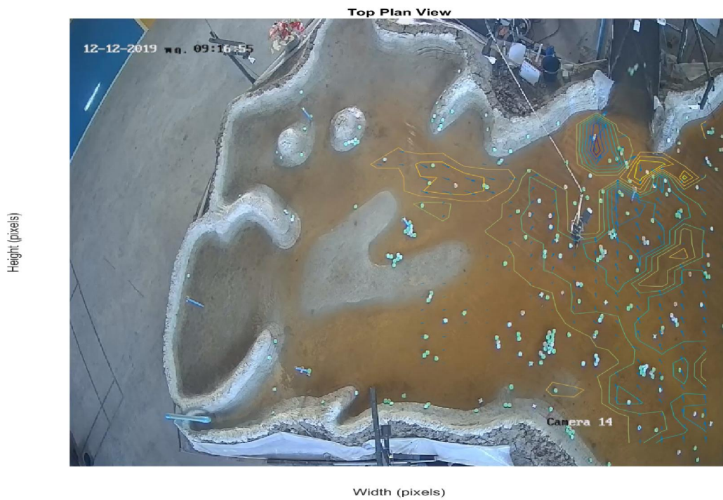
ภาพที่ ค2.8.การเคลื่อนตัวของน้ำภายในแบบจำลองอ่างเก็บน้ำแก่งกระจานด้านทิศตะวันตกเมื่อเกิดการพิบัติของเขื่อน วินาทีที่ 42
