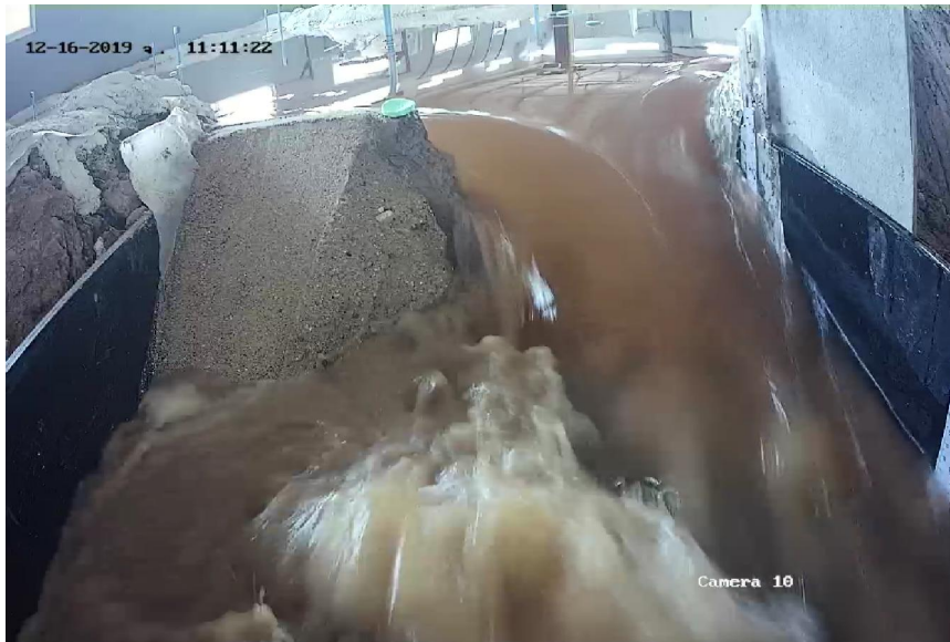
ภาพที่ ข2.5.แบบจำลองเขื่อนแก่งกระจานจำลองในขณะที่มีการถล่มของแกนดินเหนียว
