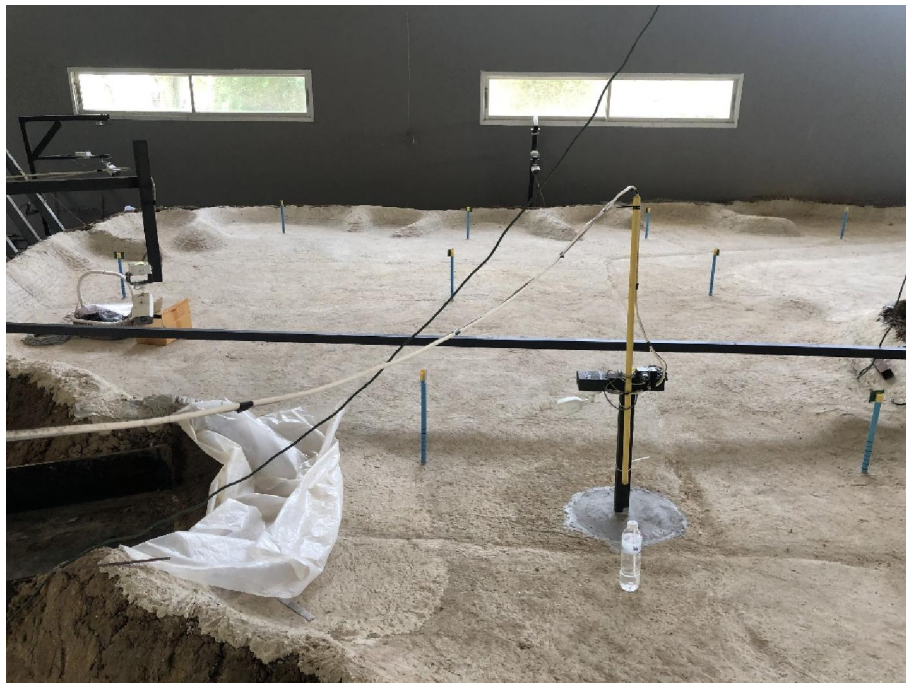
ภาพที่ 2.14 การติดตั้งระบบกล้องตรวจวัดน้ำในอ่างเก็บน้ำจำลอง
