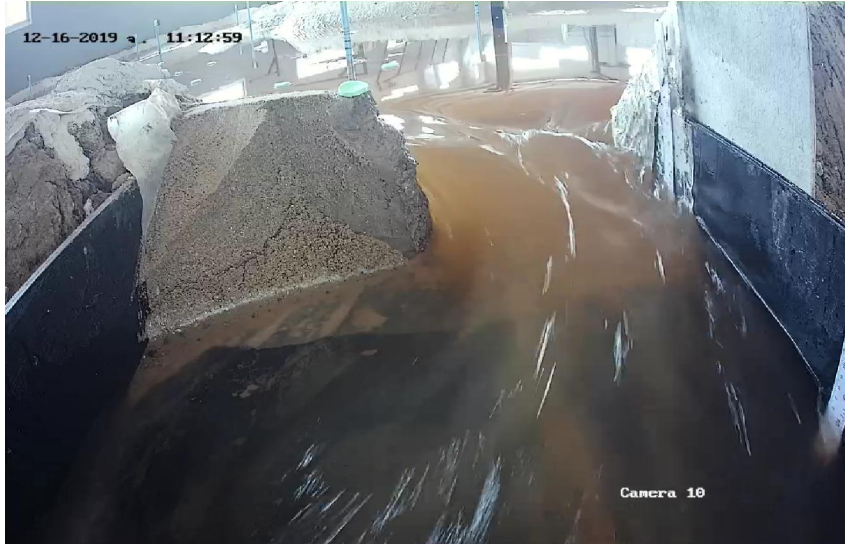
ภาพที่ ข2.7.แบบจำลองเขื่อนแก่งกระจานจำลองในขณะที่เริ่มมีการไหลซึมด้านปีกซ้ายของเขื่อน
