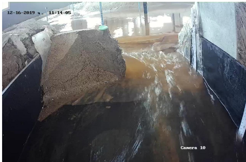
ภาพที่ ข2.8.แบบจำลองเขื่อนแก่งกระจานจำลองในขณะที่เริ่มมีการไหลซึมด้านปีกซ้ายของเขื่อน
