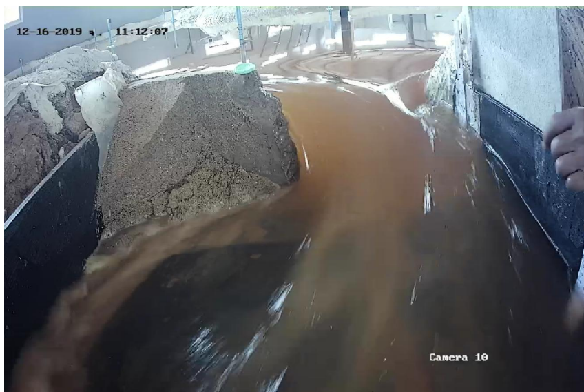
ภาพที่ ข2.6.แบบจำลองเขื่อนแก่งกระจานจำลองในขณะที่น้ำไหลทะลักผ่านตัวเขื่อนส่วนซ้ายที่แตก
