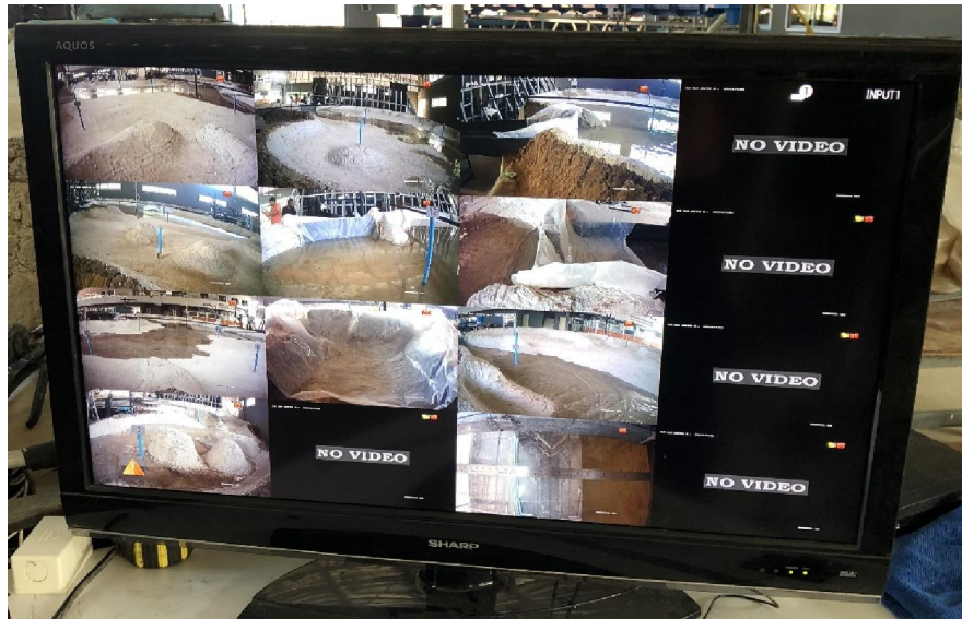
ภาพที่ 2.15 แสดงระบบกล้องตรวจวัดน้ำในอ่างเก็บน้ำจำลอง
