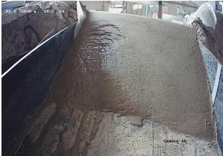
ภาพที่ ข1.3.แบบจำลองเขื่อนแก่งกระจานในขณะที่มีการทรุดตัวทางบริเวณด้านขวาของตัวเขื่อน
