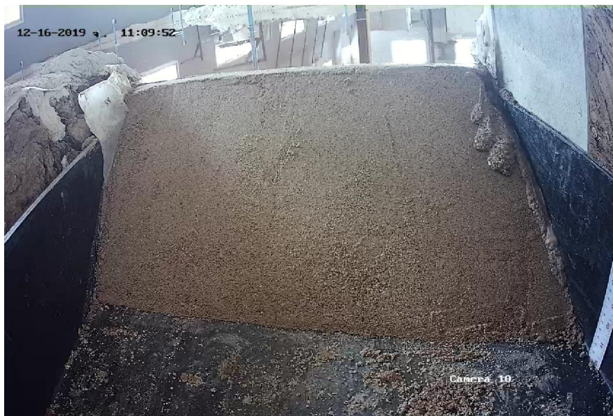
ภาพที่ ข2.2.แบบจำลองเขื่อนแก่งกระจานจำลองในขณะเริ่มมีการไหลซึมด้านปีกซ้ายของเขื่อน
