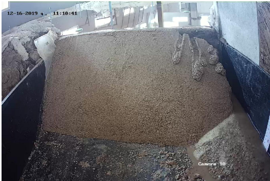
ภาพที่ ข2.3.แบบจำลองเขื่อนแก่งกระจานจำลองในขณะที่เริ่มมีการกักเซาะด้านซ้ายของเขื่อน
