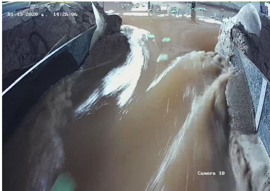
ภาพที่ ข1.6.แบบจำลองเขื่อนแก่งกระจานในขณะที่ตัวเขื่อนถูกกัดเซาะจนเป็นรอยแยกขนาดใหญ่
