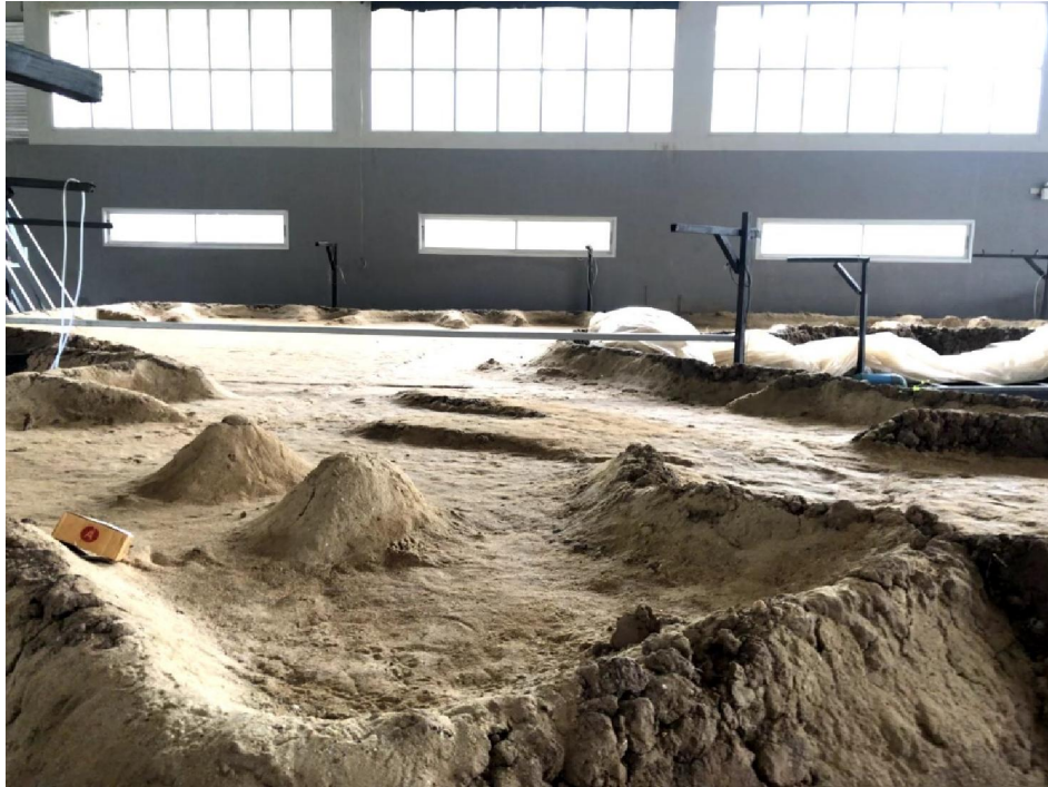
ภาพที่ 2.11 การรองพื้นอ่างเก็บน้ำด้วยทรายเพื่อปรับปริมาตรของอ่างเก็บน้ำจำลอง
