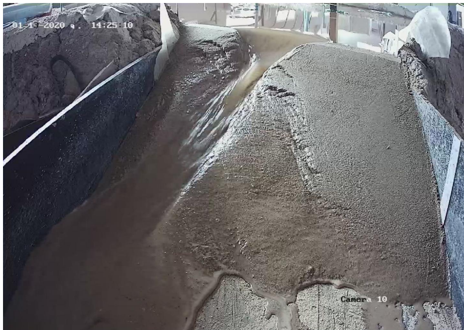
ภาพที่ ข1.4.แบบจำลองเขื่อนแก่งกระจานในขณะที่มีการไหลล้นผ่านรอยแตกของเขื่อน
