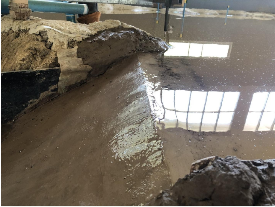
ภาพที่ 2.25 ภาพแสดงการทำลองการไหลข้ามสันเขื่อนแก่งกระจานจำลอง
