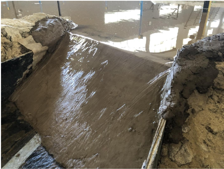
ภาพที่ 2.26 ภาพการไหลล้นข้ามสันเขื่อนแก่งกระจานจำลอง
