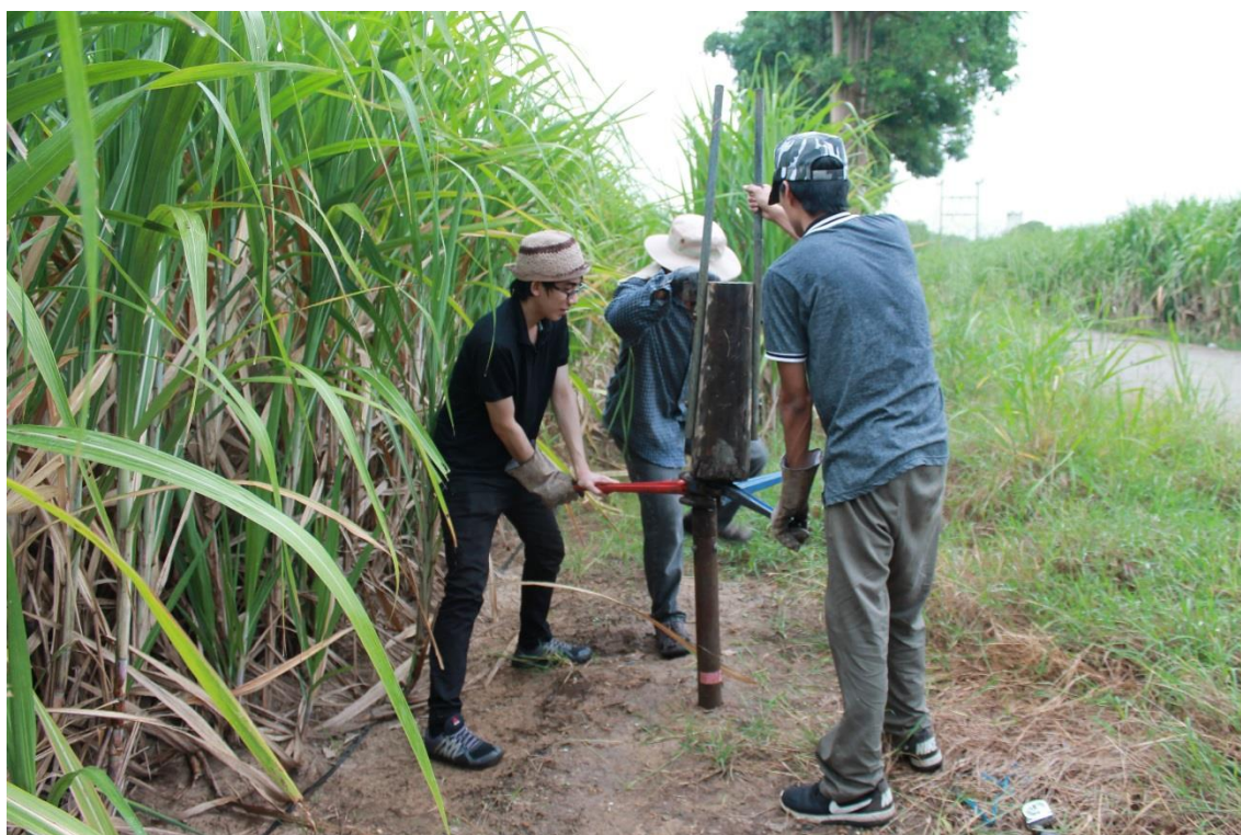
ภาพผนวกที่ B-3 การเก็บตัวอย่างดินจุดที่ 2 (พื้นที่ไร่อ้อย) แบบคงสภาพ (Undisturbed Soil Sample) โดยอุปกรณ์กระบอกเก็บตัวอย่างดินแบบเปลือกบาง
