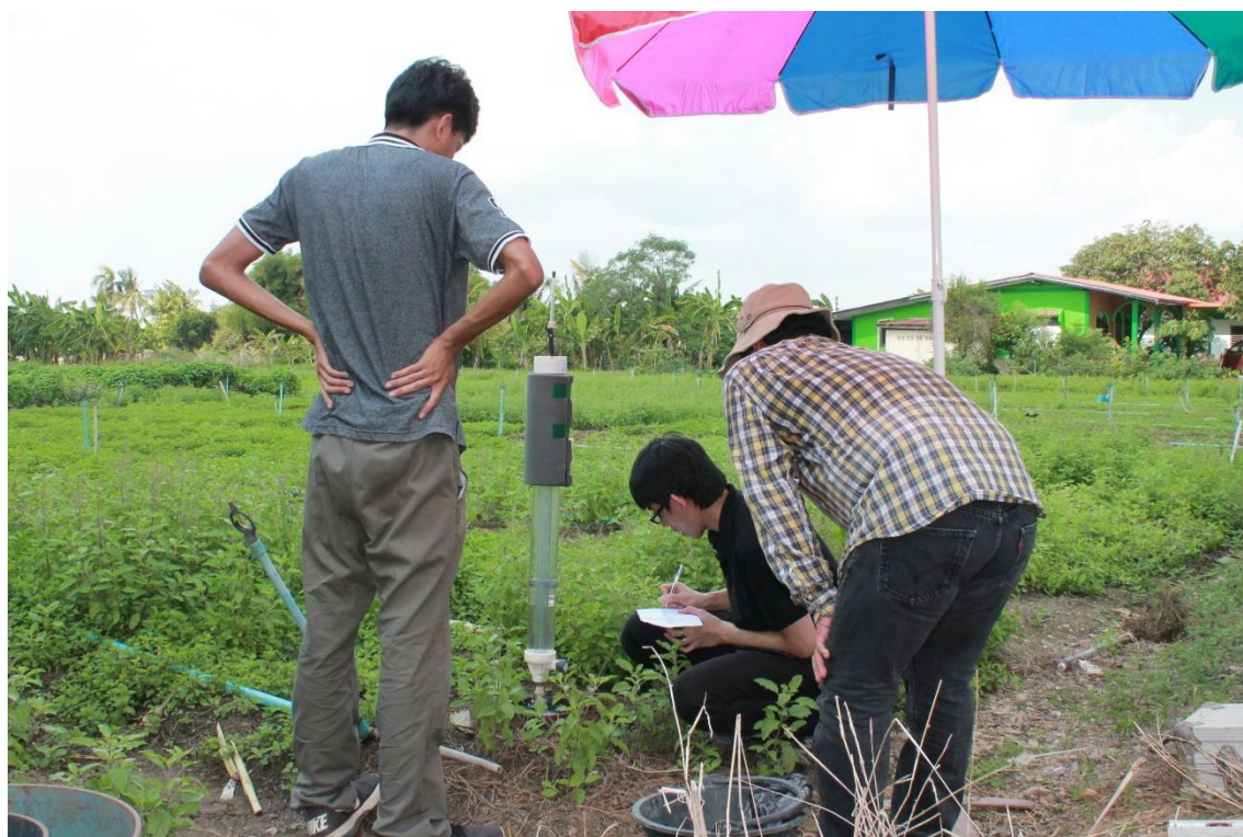
ภาพผนวกที่ C-7 ขั้นตอนการจดบันทึกค่าระดับน้ำที่ลดลงของเครื่องมือตรวจวัดอัตราการซึมของน้ำ ชนิดแรงดึงกลับ (Tension Infiltrometer) จุดที่ 3 (พื้นที่ปลูกผักสวนครัว)
