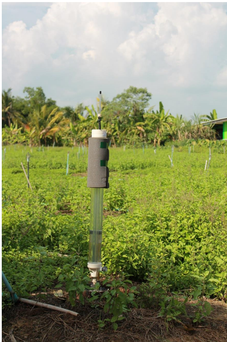
ภาพผนวกที่ C-6 ขั้นตอนการติดตั้งเครื่องมือตรวจวัดอัตราการซึมของน้ำชนิดแรงดึงกลับ (Tension Infiltrometer) จุดที่ 3 (พื้นที่ปลูกผักสวนครัว)
