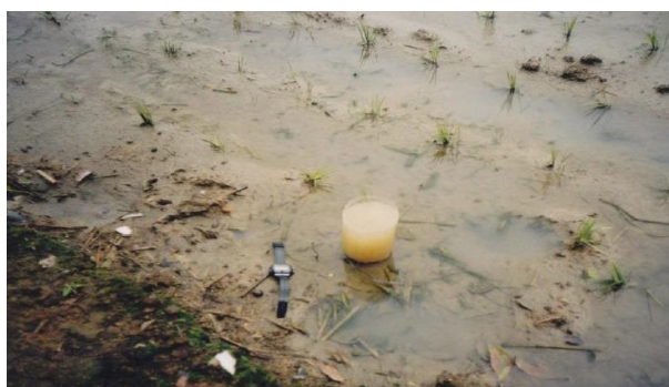
ภาพที่ 1-20 วิธีการตรวจวัดค่าความนำน้ำชลศาสตร์ในรูปของอัตราการซึมของน้ำลงดินโดยใช้ถังวัดอัตราการซึมของน้ำลงดินชนิดวงแหวนเดี่ยว
