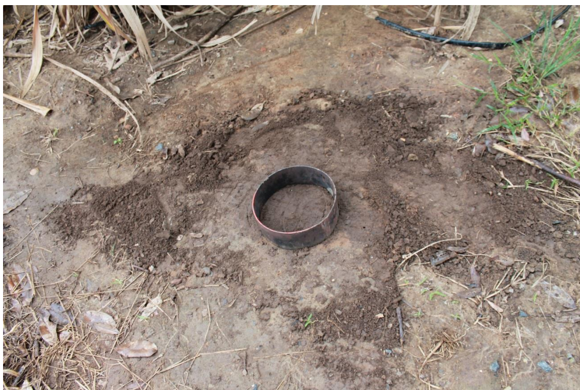
ภาพผนวกที่ B-7 ขั้นตอนการเตรียมหน้าดินเพื่อติดตั้งถังวัดอัตราการซึมของน้ำชนิดวงแหวนคู่ (Double-Ring Infiltrometer) จุดที่ 2 (พื้นที่ไร่ย่อย)
