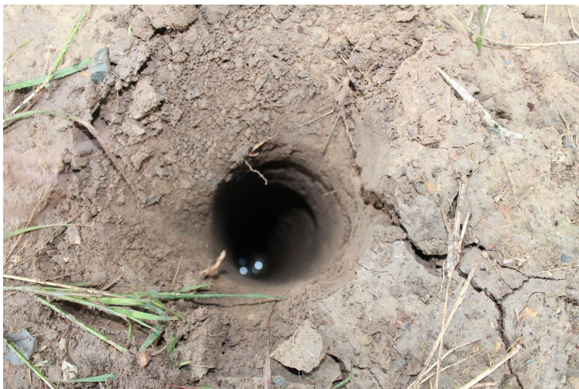
ภาพผนวกที่ B-4 ความลึกของการเก็บตัวอย่างดินจุดที่ 2 (พื้นที่ไร่อ้อย) ประมาณ 1.50 เมตร เลขเซต รากพืช
