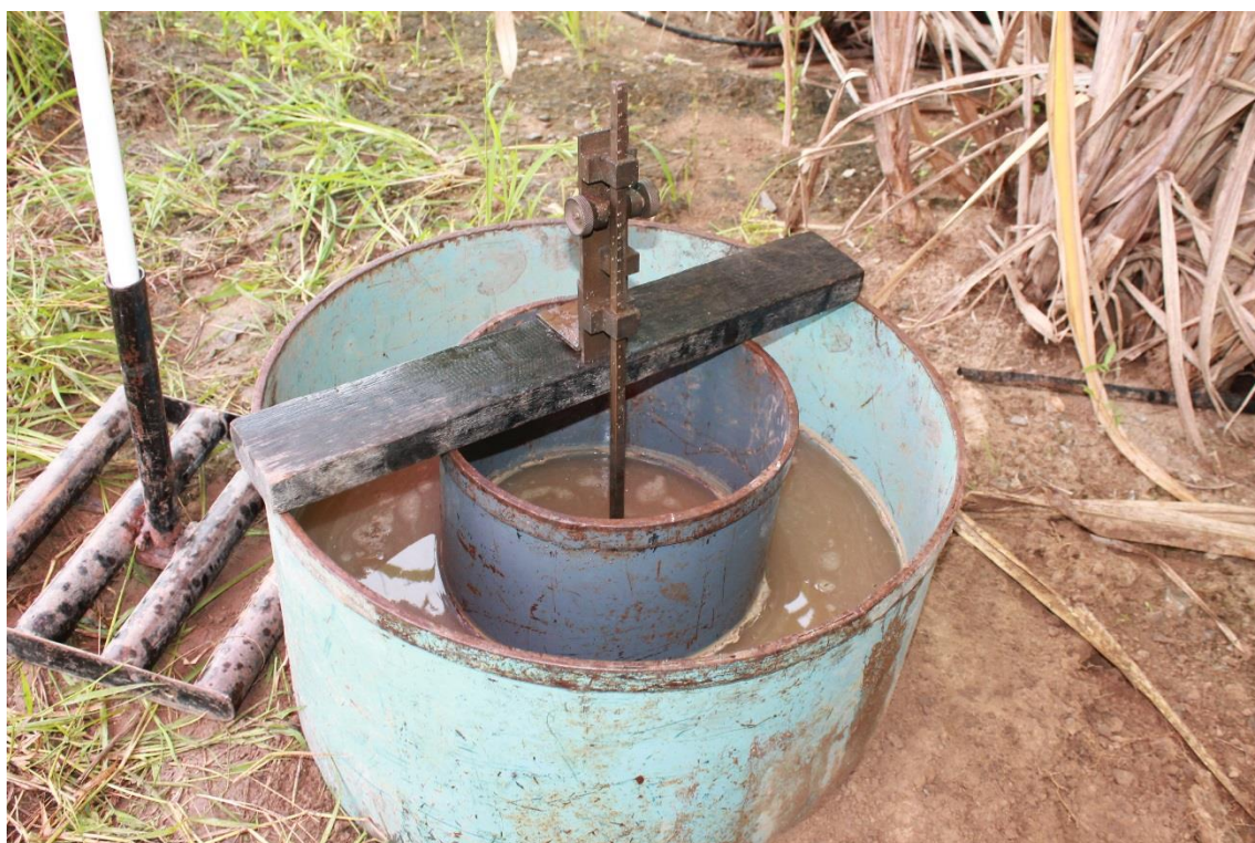
ภาพผนวกที่ B-9 ขั้นตอนการติดตั้งเกจอ่านค่าระดับน้ำและเติมน้ำลงในถังวัดอัตราการซึมของน้ำชนิดวงแหวนคู่ (Double-Ring Infiltrometer)
