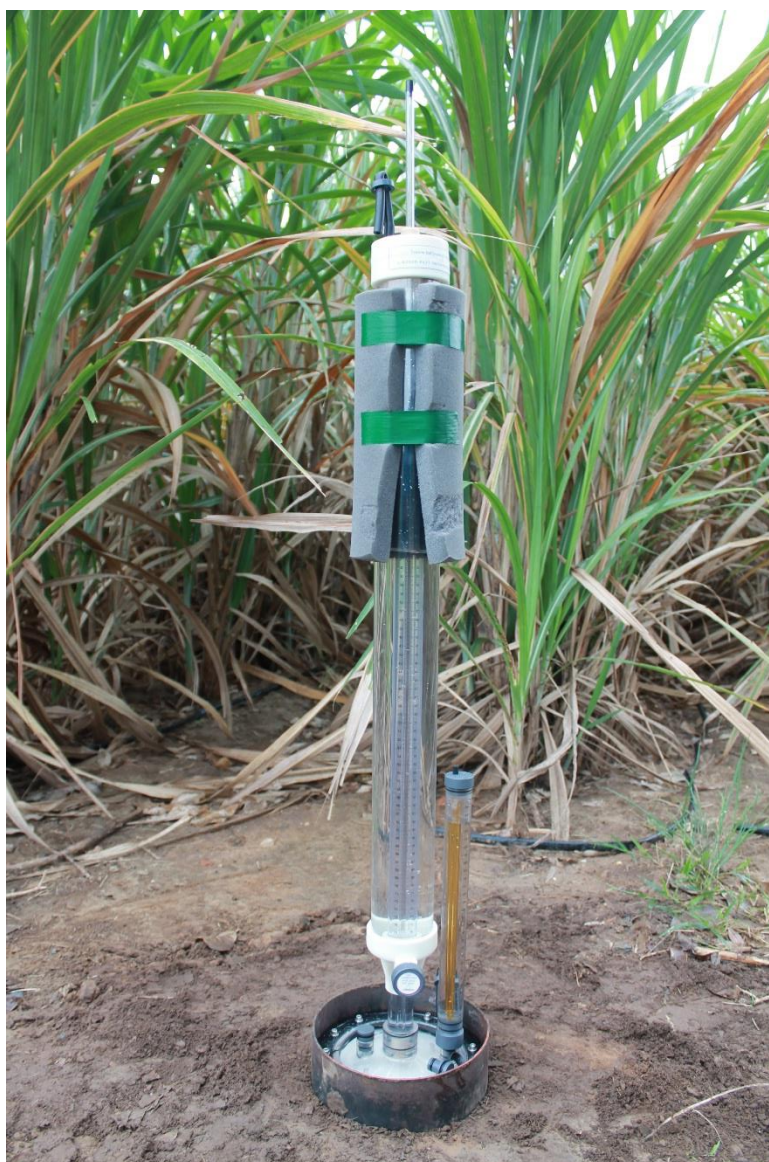
ภาพผนวกที่ B-11 ขั้นตอนการติดตั้งเครื่องมือตรวจวัดอัตราการซึมของน้ำชนิดแรงดึงกลับ (Tension Infiltrometer) ในดินจุดที่ 2 (พื้นที่ไร่อ้อย)
