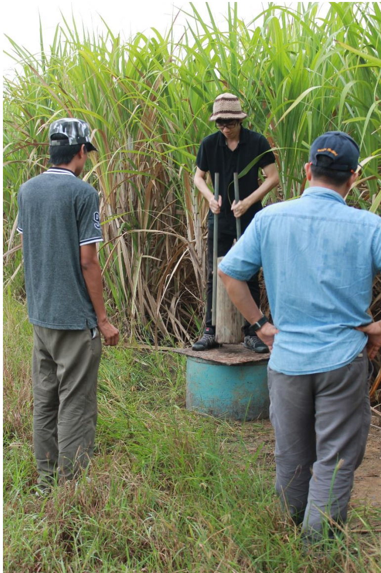
ภาพผนวกที่ B-8 ขั้นตอนการติดตั้งถึงวัดอัตราการซึมของน้ำชนิดวงแหวนคู่ (Double-Ring Infiltrometer) ให้มีความลึกลงไป 15 เซนติเมตร โดยใช้ค้อนไม้ตอกด้วยแรงคน
