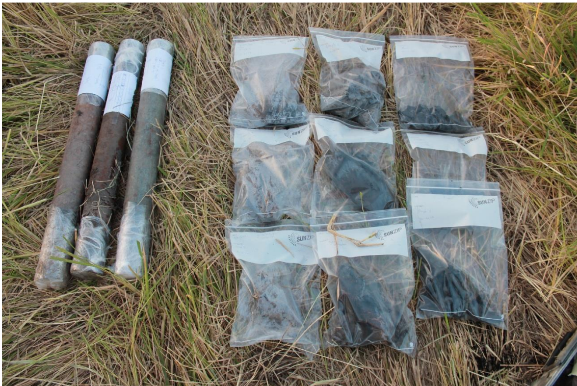
ภาพผนวกที่ A-6 ตัวอย่างดินจุดที่ 1 (พื้นที่นาข้าว) แบบคงสภาพ (Undisturbed Soil Sample) -รูปซ้ายมือ และแบบเปลี่ยนสภาพ (Disturbed Soil Sample)-รูปขวามือ
