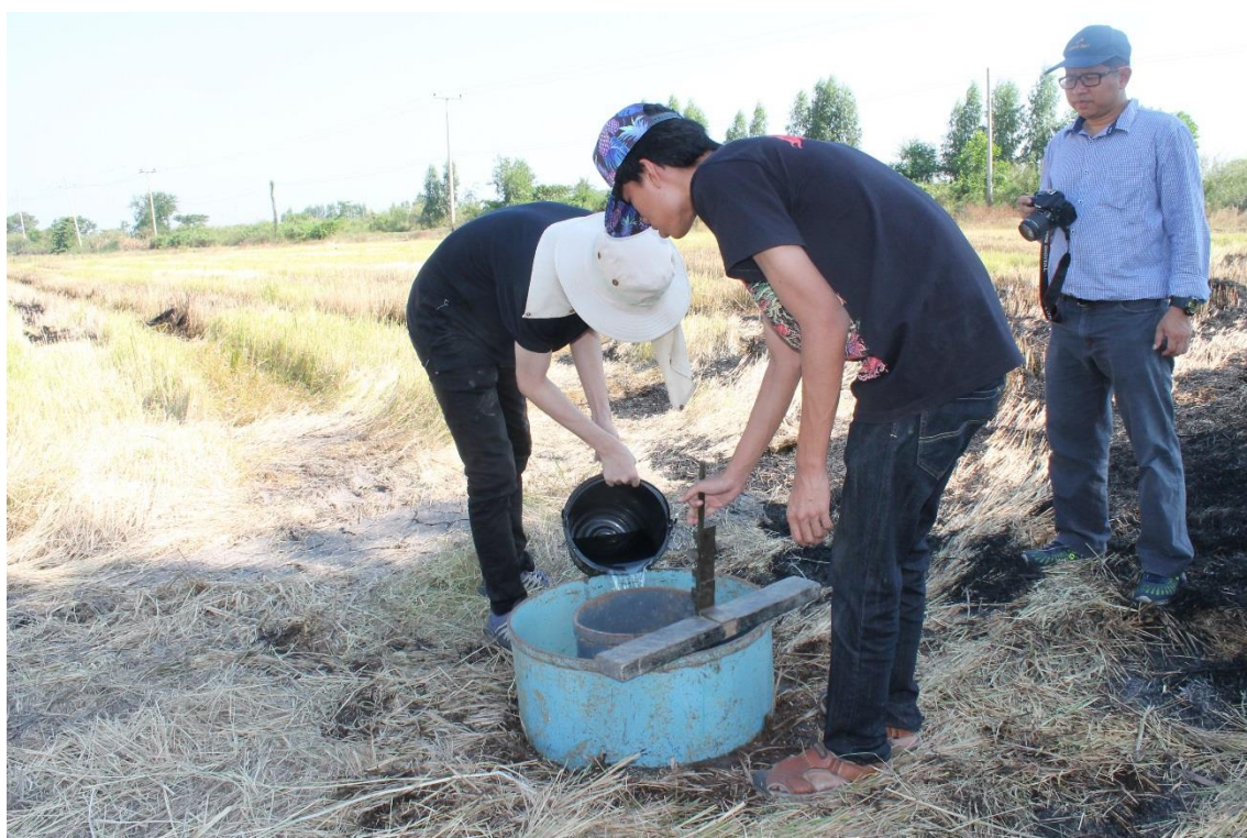
ภาพผนวกที่ A-10 ขั้นตอนการเติมน้ำลงในถังวัดอัตราการซึมของน้ำชนิดวงแหวนคู่ (Double-Ring Infiltrometer) ทั้งวงแหวนในและวงแหวนนอกที่ระดับน้ำเดียวกัน
