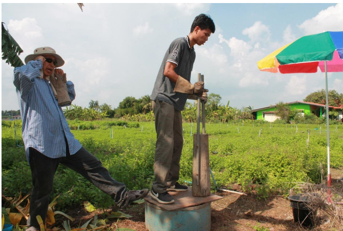
ภาพผนวกที่ C-5 ขั้นตอนการติดตั้งถังวัดอัตราการซึมของน้ำชนิดวงแหวนคู่ (Double-Ring Infiltrometer) ให้มีความลึกลงไป 15 เซนติเมตร โดยใช้ค้อนไม้ต่อกด้วยแรงคน
