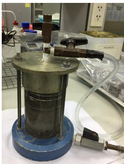
ภาพที่ 2-24 โครงสร้างของอุปกรณ์ทดสอบการซึมผ่านของน้ำในห้องปฏิบัติการ
