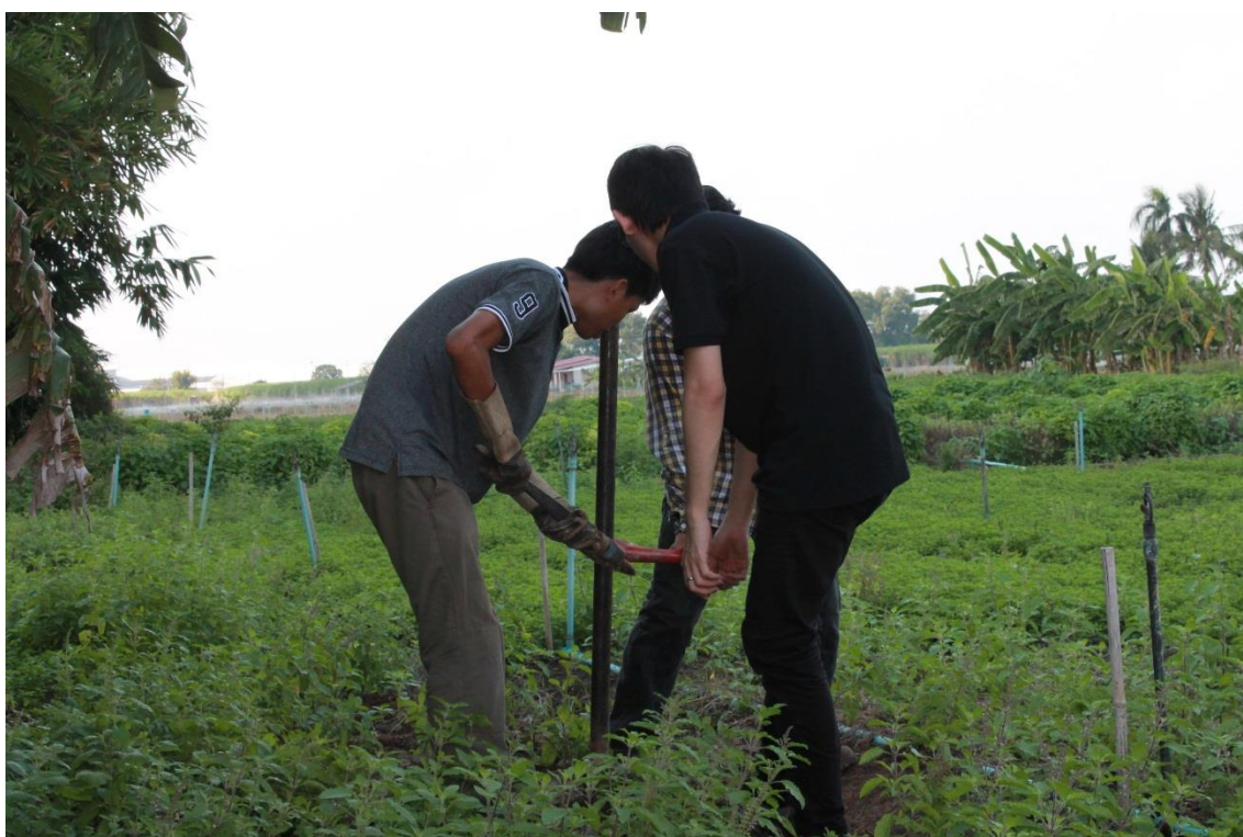
ภาพผนวกที่ C-2 การเก็บตัวอย่างดินจุดที่ 3 (พื้นที่ปลูกผักสวนครัว) แบบคงสภาพ (Undisturbed Soil Sample) โดยอุปกรณ์กระบอกเก็บตัวอย่างดินแบบเปลือกบาง
