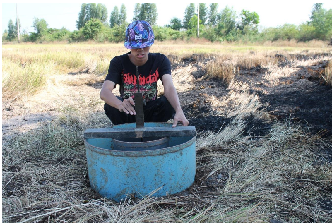
ภาพผนวกที่ A-9 ขั้นตอนการติดตั้งเกจอ่านค่าระดับน้ำบนถังวัดอัตราการซึมของน้ำชนิดวงแหวนคู่ (Double-Ring Infiltrometer)
