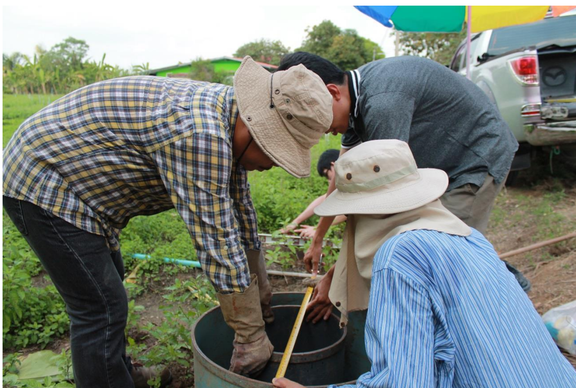
ภาพผนวกที่ C-4 ขั้นตอนการติดตั้งถึงวัดอัตราการซึมของน้ำชนิดวงแหวนคู่ (Double-Ring Infiltrometer)
