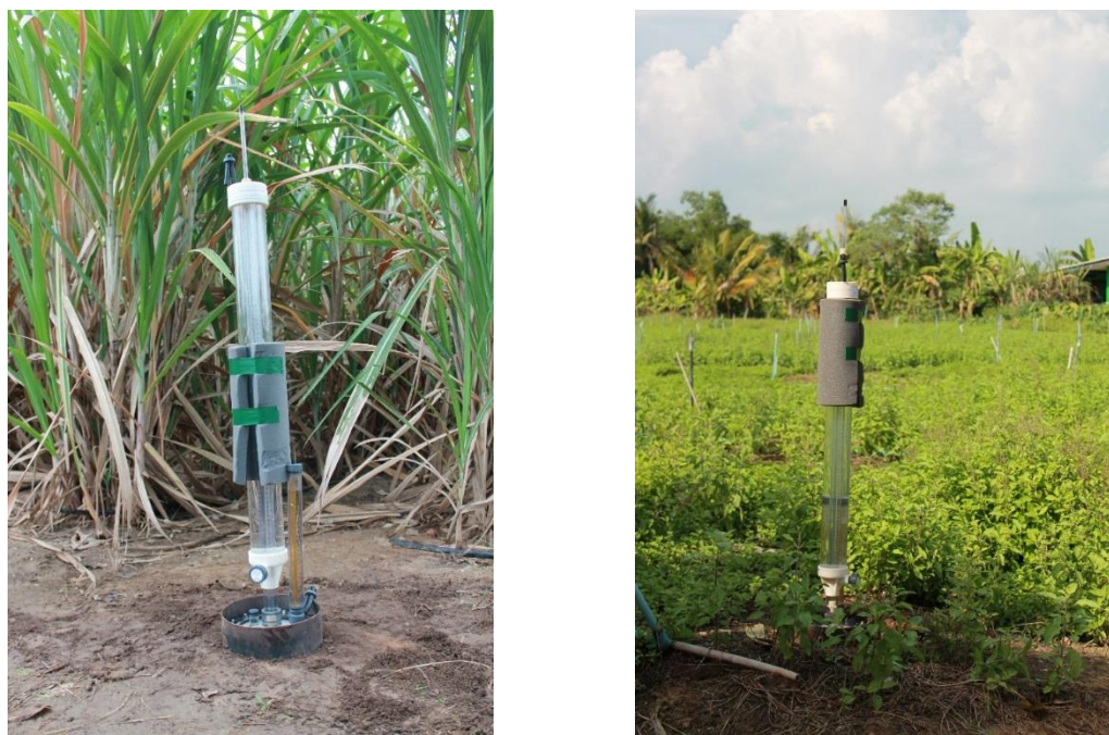
ภาพที่ 2-20 การตรวจวัดอัตราการซึมของน้ำด้วย Tension Infiltrometer
