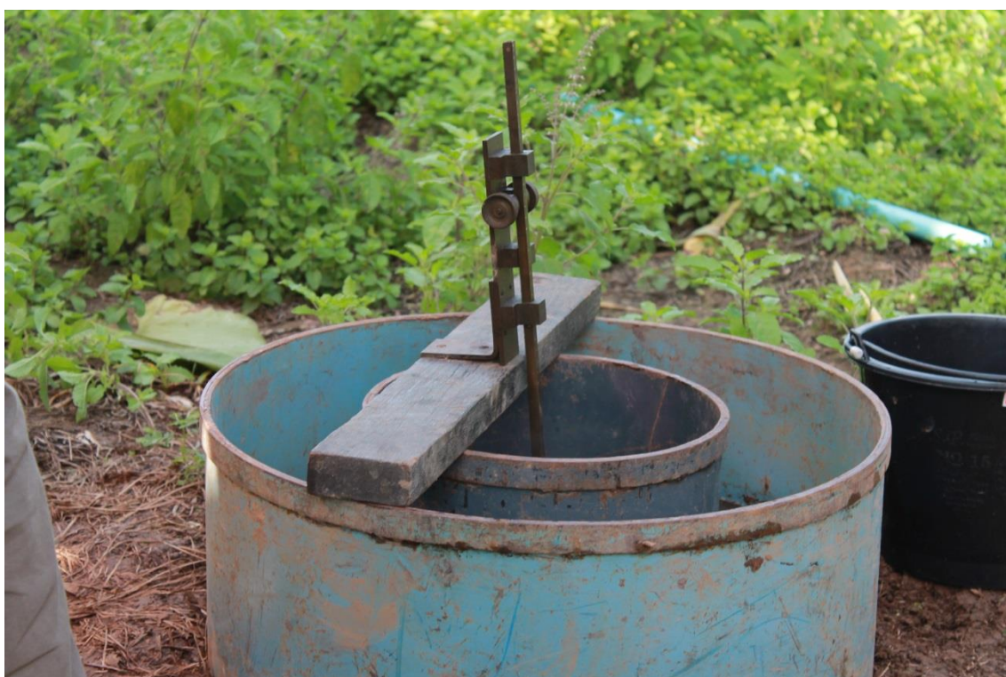
ภาพผนวกที่ C-6 ขั้นตอนการติดตั้งเกจอ่านค่าระดับน้ำบนถังวัดอัตราการซึมของน้ำชนิดวงแหวนคู่ (Double-Ring Infiltrometer)
