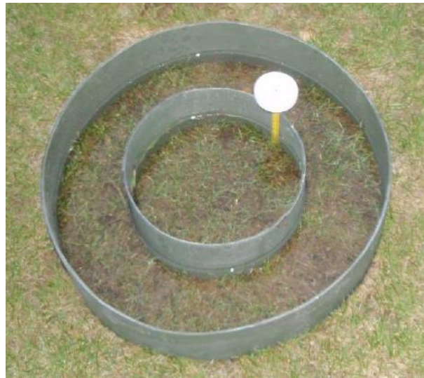
ภาพที่ 1-21 วิธีการตรวจวัดค่าความนำน้ำชลศาสตร์ในรูปของอัตราการซึมของน้ำลงดินโดยใช้ถังวัดอัตราการซึมของน้ำลงดินชนิดวงแหวนคู่
