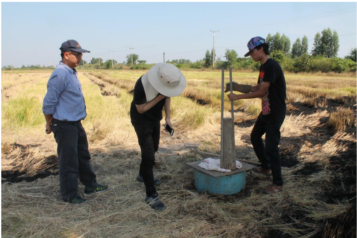
ภาพผนวกที่ A-8 ขั้นตอนการติดตั้งถังวัดอัตราการซึมของน้ำชนิดวงแหวนคู่ (Double-Ring Infiltrometer) ให้มีความลึกลงไป 15 เซนติเมตร โดยใช้ค้อนไม้ตอกด้วยแรงคน
