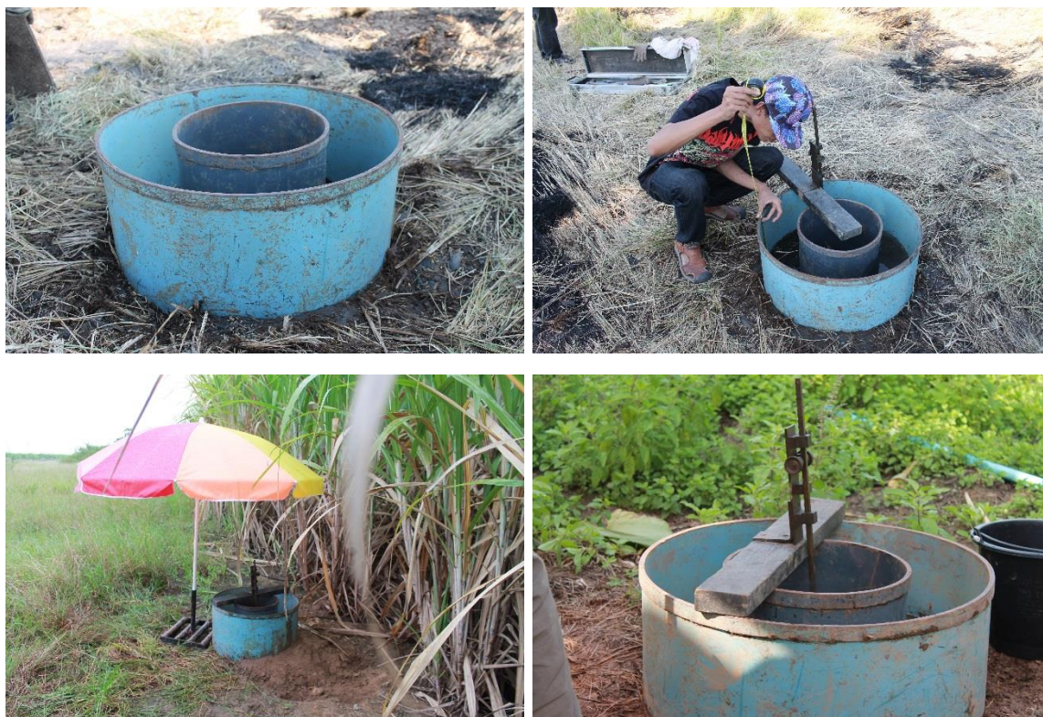
ภาพที่ 2-19 การตรวจวัดอัตราการซึมของน้ำด้วย Double-Ring Infiltrometer
