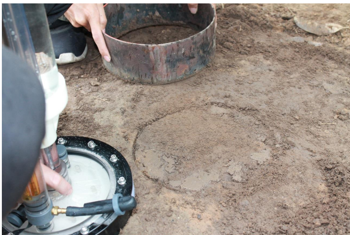
ภาพผนวกที่ B-10 ขั้นตอนการเตรียมหน้าดินเพื่อติดตั้งเครื่องมือตรวจวัดอัตราการซึมของน้ำชนิดแรงดึง (Tension Infiltrometer) ในดินจุดที่ 2 (พื้นที่ไร่อ้อย)
