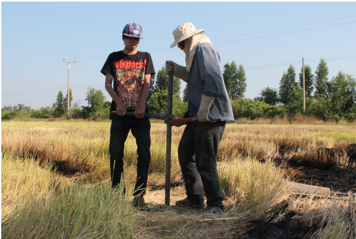
ภาพผนวกที่ A-4 การเก็บตัวอย่างดินจุดที่ 1 (พื้นที่นาข้าว) แบบคงสภาพ (Undisturbed Soil Sample) โดยอุปกรณ์กระบอกเก็บตัวอย่างดินแบบเปลือกบาง
