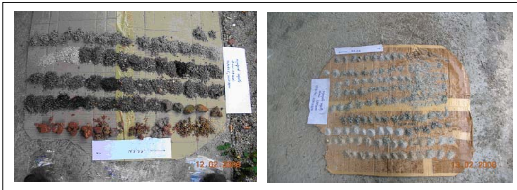
รูปที่ 3 - 4 ภาพถ่ายแสดงตัวอย่าง cutting จากการเจาะบ่อสำรวจ
