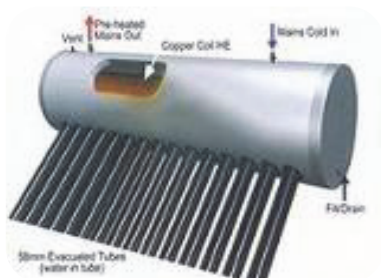
รูปที่ 2.4.7 การผลิตน้ำร้อนชนิดไหลเวียนตามธรรมชาติ (กรมพัฒนาพลังงานทดแทนและอนุรักษ์พลังงาน 2548)
