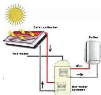
รูปที่ 2.4.9 การผลิตน้ำร้อนชนิดผสมผสาน
