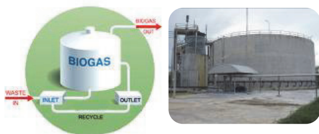
รูปที่ 2.4.10 ระบบบำบัดน้ำเสียแบบยูเอเอสบี (กรมโรงงานอุตสาหกรรม 2552)
