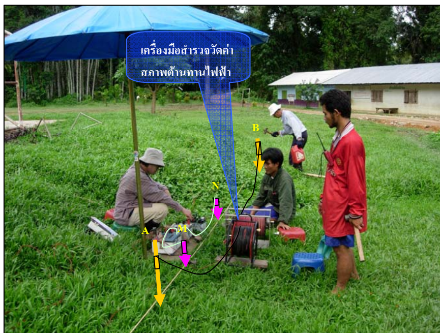
รูปที่ 3-7 การวางขั้วไฟฟ้าแบบชลัมเบอร์เจอร์ในพื้นที่สำรวจ
