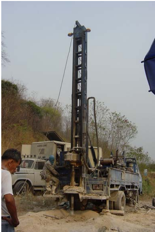
(ก) แสดงเครื่องเจาะแบบตกรัดและเครื่องปั๊มลม
