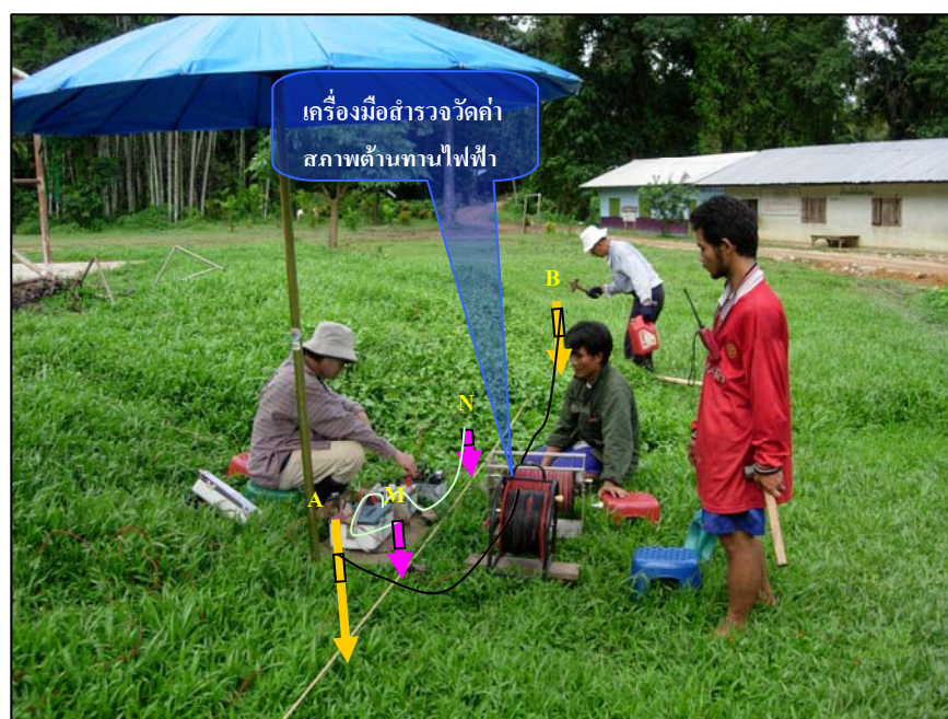
รูปที่ 3-7 การวางขั้วไฟฟ้าแบบขั้วลัมเบอร์เจอร์ในพื้นที่สำรวจ
