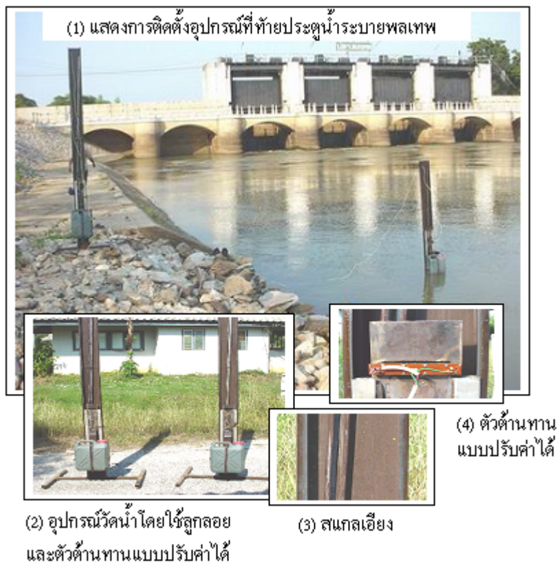
รูปที่ 1 อุปกรณ์วัดระดับน้ำแบบลูกลอยโดยใช้ตัวต้านทานแบบปรับค่าได้
