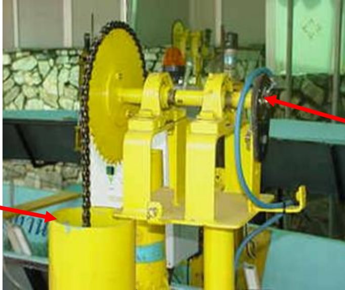
รูปที่ 2 อุปกรณ์วัดระดับน้ำแบบลูกลอยโดยใช้ Potentiometer แบบกลม
