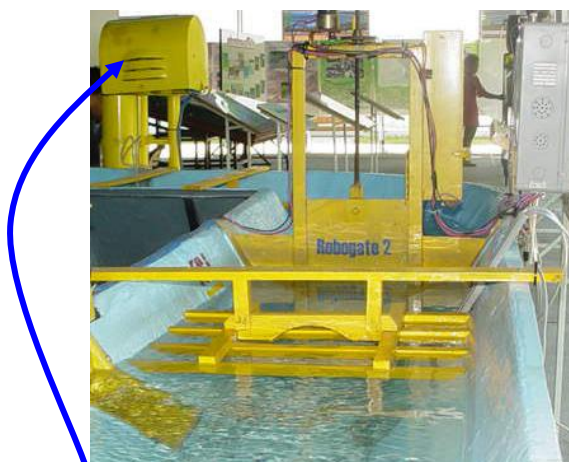
(1) การติดตั้ง Sensor วัดระดับน้ำแบบลูกลอย ในแบบจำลองคลอง
