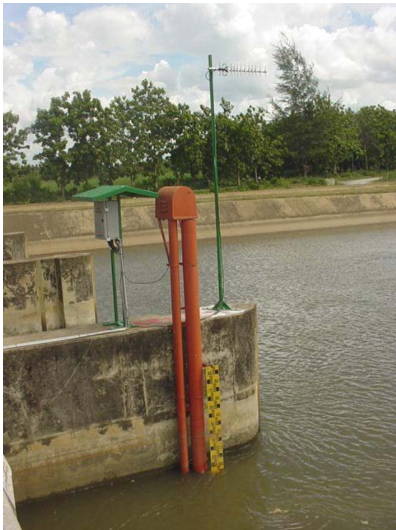
รูปที่ 30 การติดตั้งสายอากาศและแผ่นวัดระดับน้ำหน้าประตูระบายน้ำ
