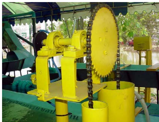
(2) ระบบเฟืองและโซ่ซึ่งเชื่อมต่อกับลูกลอยกับ Potentiometer
