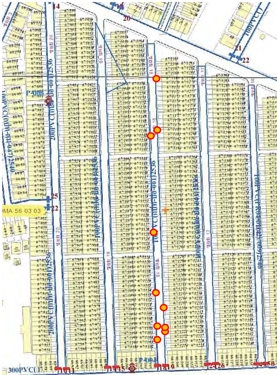
รูปที่ 5-35 ตำแหน่งจุดรั้วที่สำรวจพบด้วยอุปกรณ์วิเคราะห์เสียงน้ำรั่วแบบพกพา ม.พระปิ่น 3 สสมส.
