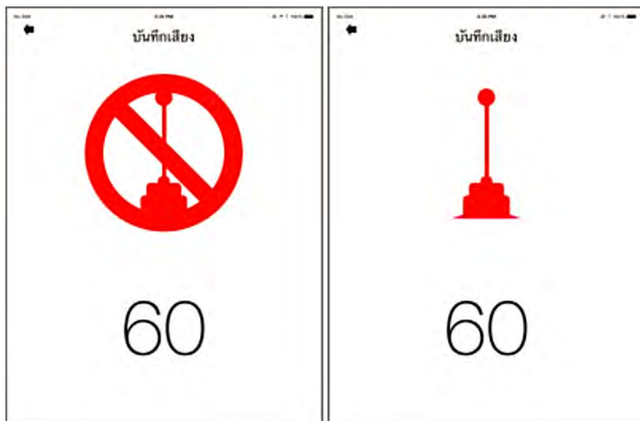
รูปที่ 2-13 หน้าจอบันทึกเสียงน้ำรั่ว (ซ้าย) ยังไม่ได้เชื่อมต่อเซนเซอร์ (ขวา) เชื่อมต่อเซนเซอร์แล้ว
