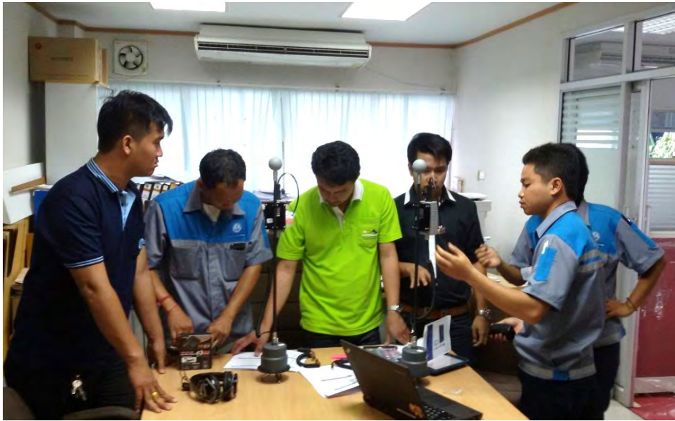
รูปที่ 4-6 ตัวแทนสาขาทดลองใช้งานอุปกรณ์วิเคราะห์เสียงน้ำรั่วแบบพกพา
