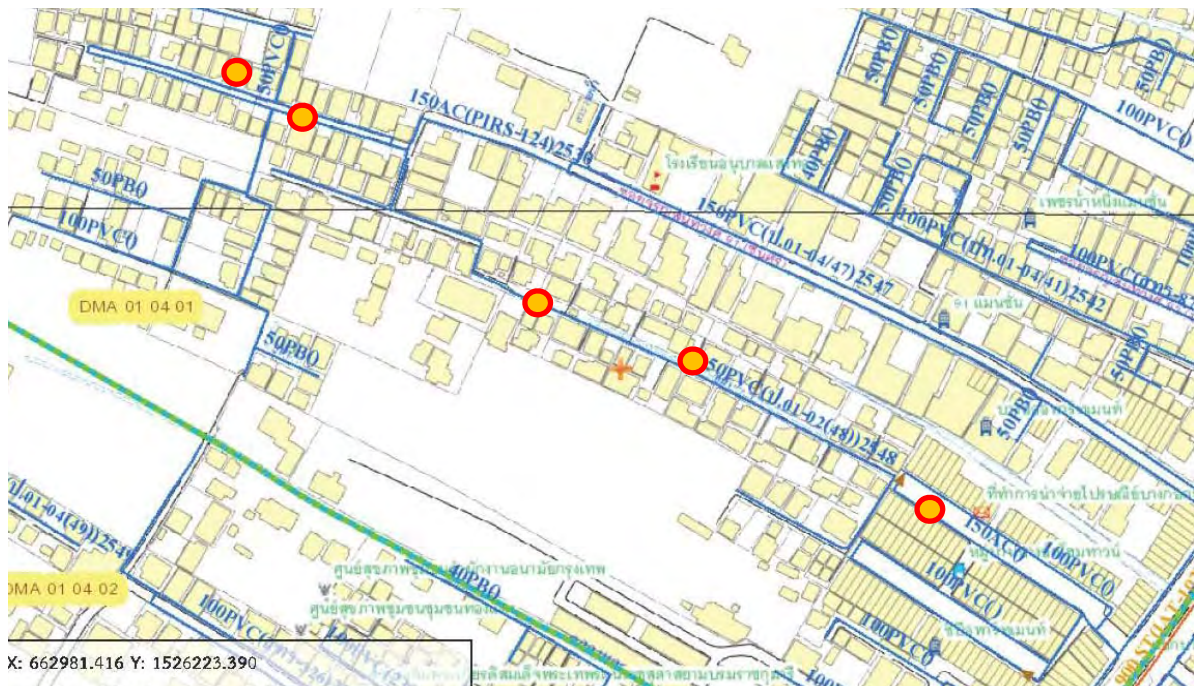
รูปที่ 5-29 ตำแหน่งจุดรั่วที่สำรวจพบด้วยอุปกรณ์วิเคราะห์เสียงน้ำรั่วแบบพกพา ซ.เจริญสนิทวงศ์ 89/2,91 สสบ.
