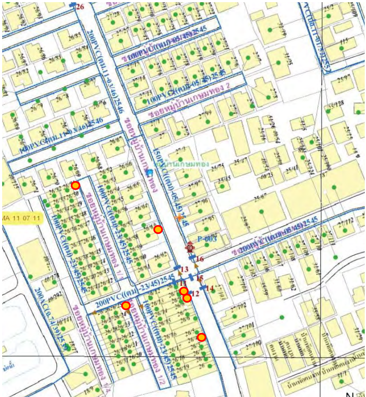
รูปที่ 5-19 ตำแหน่งจุดรั้วที่สำรวจพบด้วยอุปกรณ์วิเคราะห์เสียงน้ำรั่วแบบพกพา ม.เกษมทอง สสม. (ต่อ)
