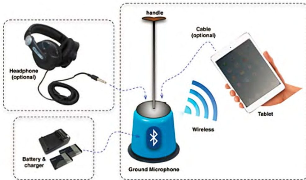
รูปที่ 2-1 แผนผังอุปกรณ์วิเคราะห์เสียงน้ำรั่วแบบพกพา
