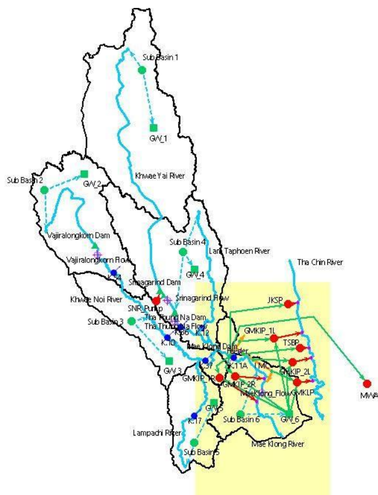
ภาพที่ 2-48 การเชื่อมโยงโหนดความต้องการน้ำผิวดินและน้ำใต้ดินที่กำหนดในแบบจำลอง WEAP-MODFLOW
