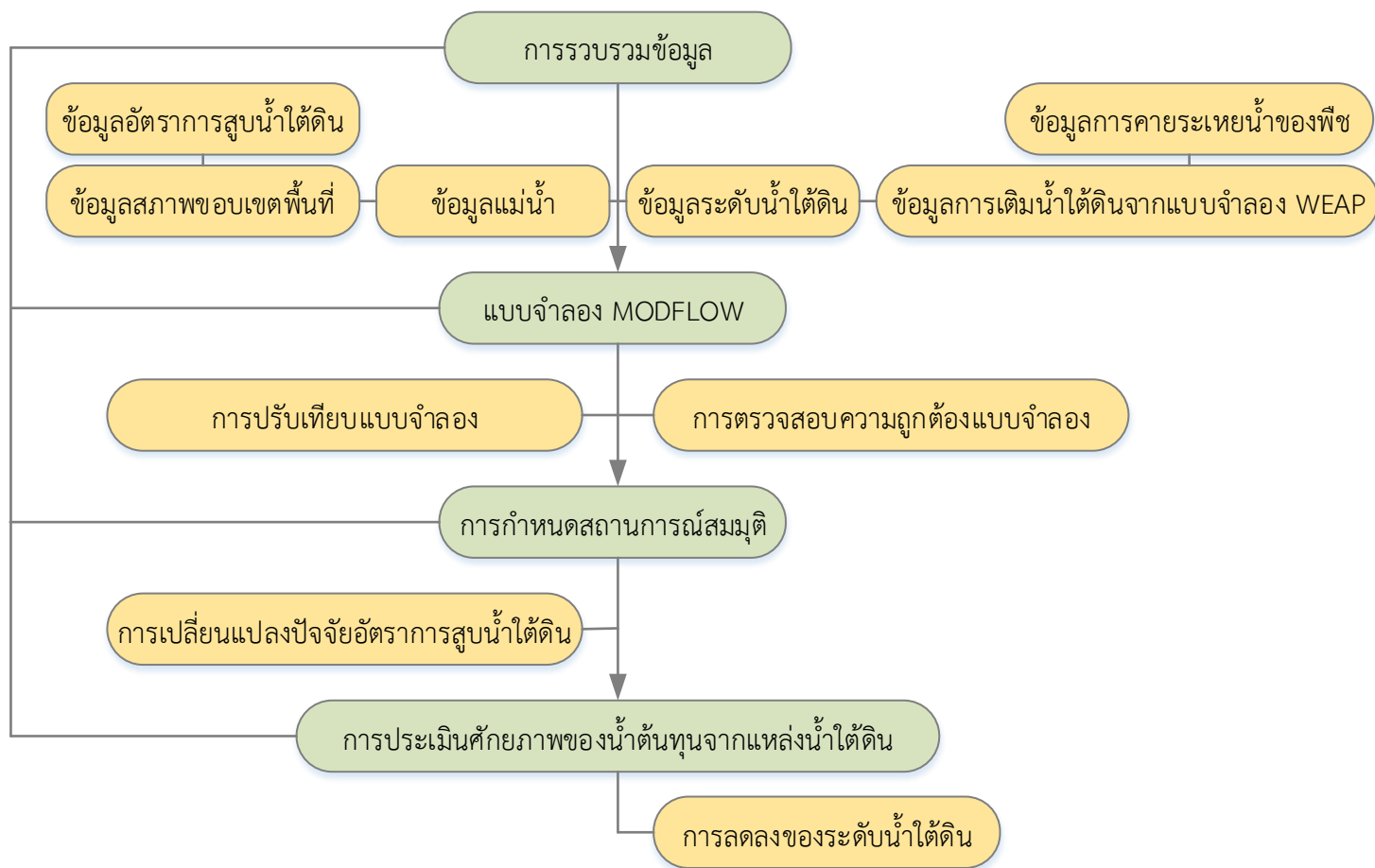
ภาพที่ 1-4 ขั้นตอนการสร้างแบบจำลอง VISUAL MODFLOW และรายละเอียดขั้นตอนการประเมินศักยภาพของน้ำต้นทุนจากแหล่งน้ำใต้ดิน
