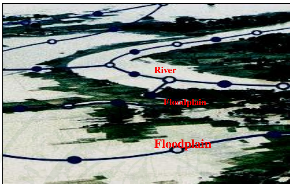
ภาพที่ 4 การจำลองระบบแม่น้ำของแบบจำลอง MIKE11-HD
